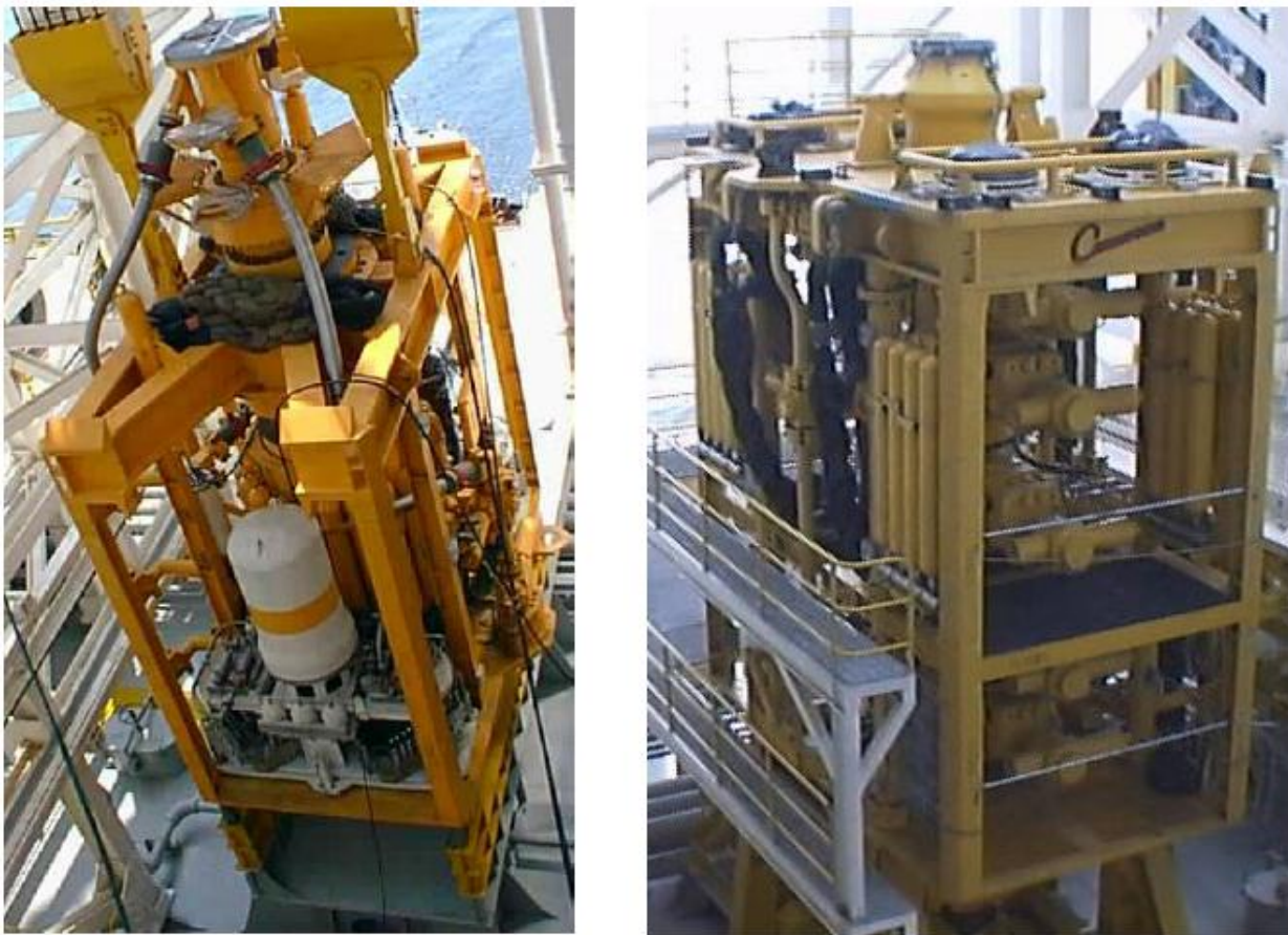
Figura 60. Imágenes del preventor anular submarino (Wild Well Control, s.f, p.110).
