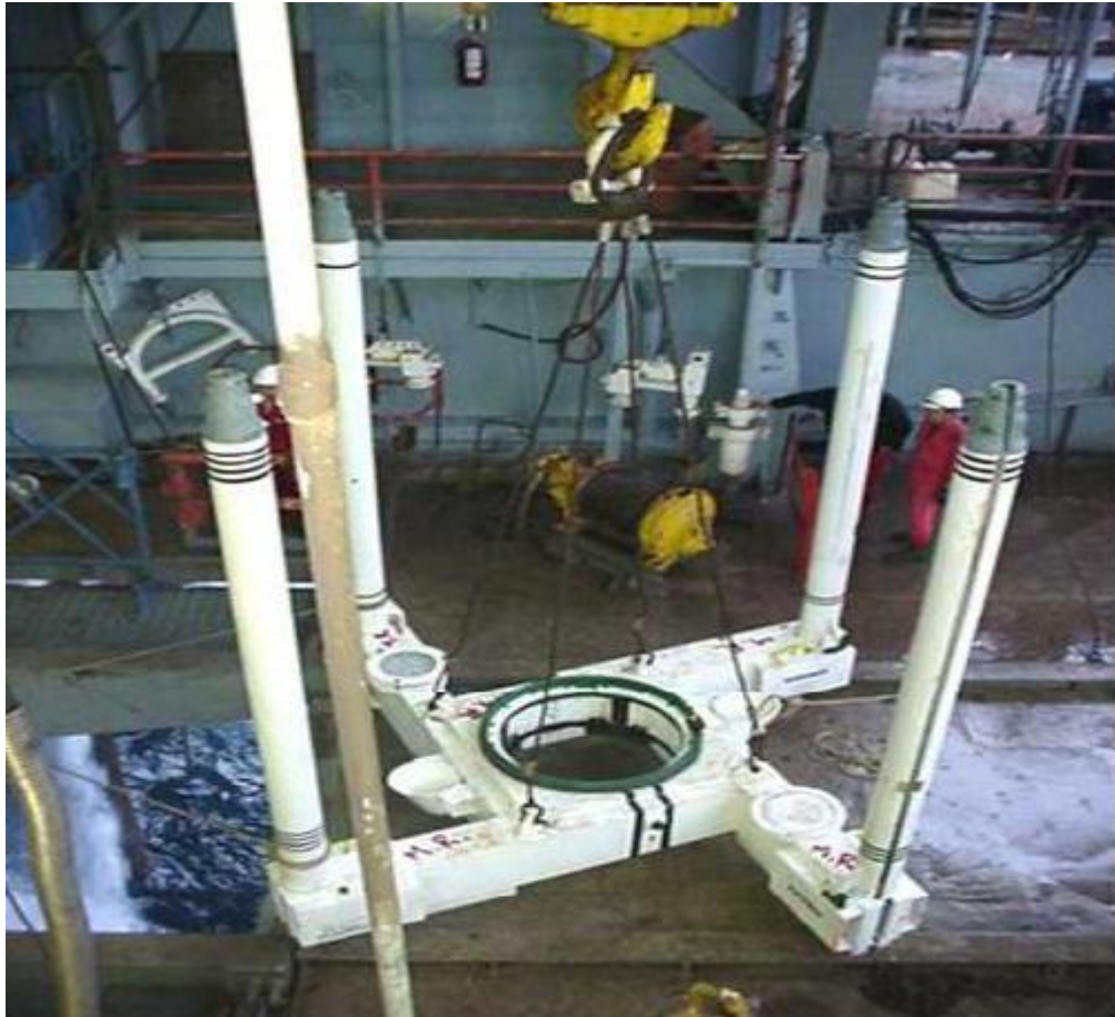
Figura 50. Base guía permanente (Montiel, 2013, pp.84 -124).
