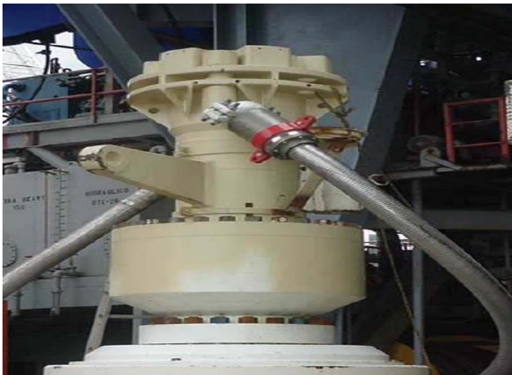
Figura 61. Conexiones de la línea de estrangulamiento (Montiel, 2013, pp.84 -124).
