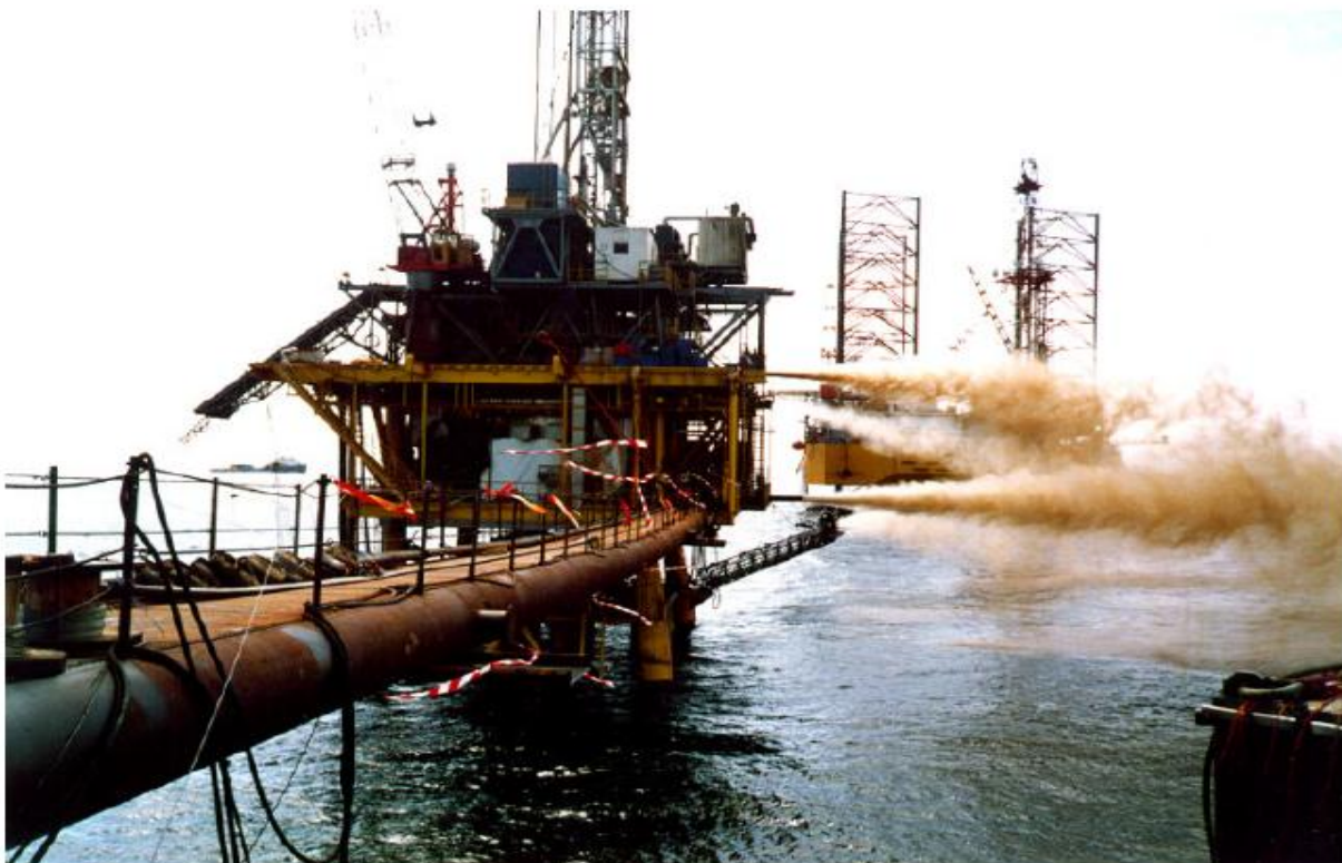
Figura 64. Sistema de desviación (Wild Well Control, s.f, p.30).
