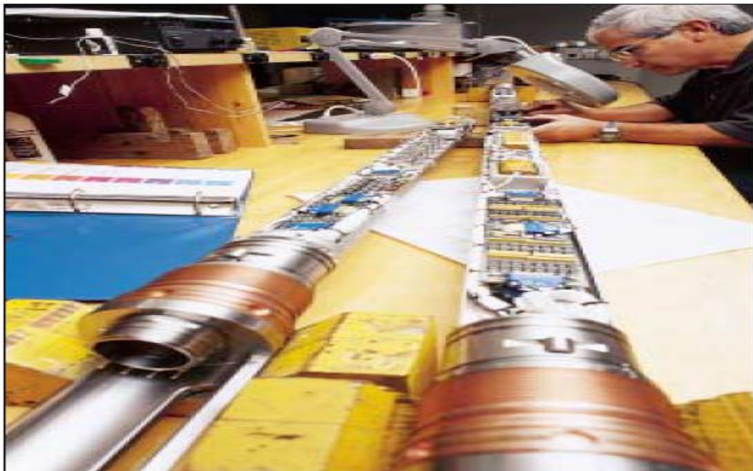
Figura 10. Dentro del sistema SenTREE7 el módulo electrónico interpreta las señales multiplexadas enviadas desde la superficie para controlar las funciones de la herramienta (Brandt et al., 1998, p.8).
