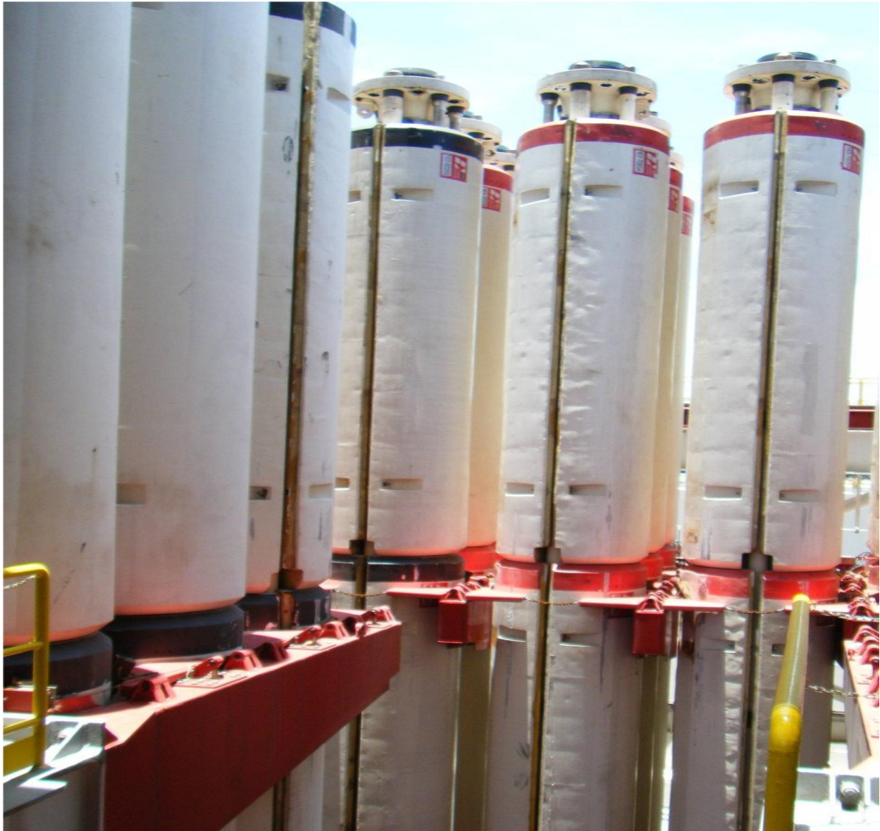
Figura 54. Los Riser o conductores marinos se encuentran cubiertos por materiales especiales que logran mantenerlos a flote (Montiel, 2013, pp.84 -124).
