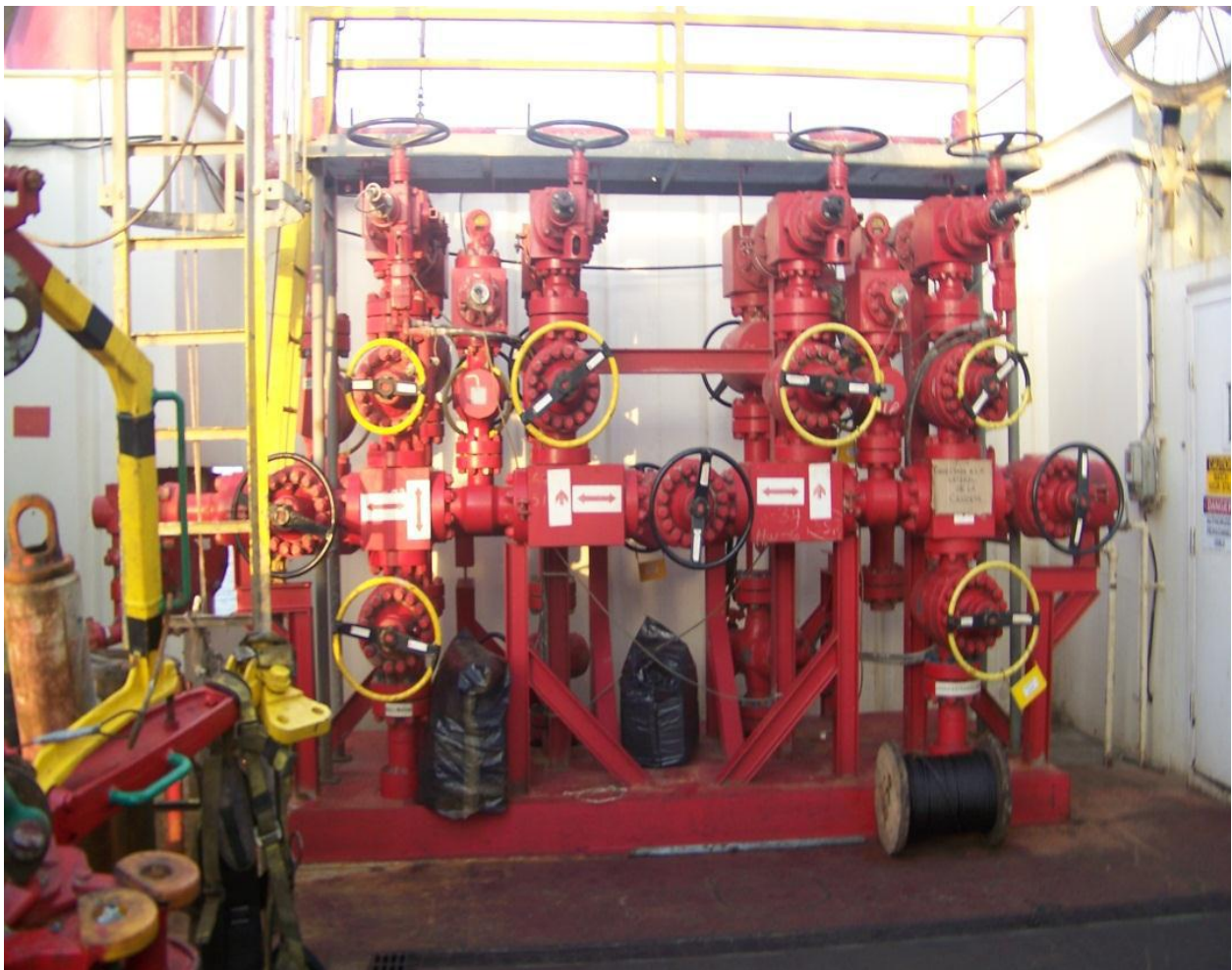
Figura 63. Múltiple de estrangulación. (Montiel, 2013, pp.84 -124)
