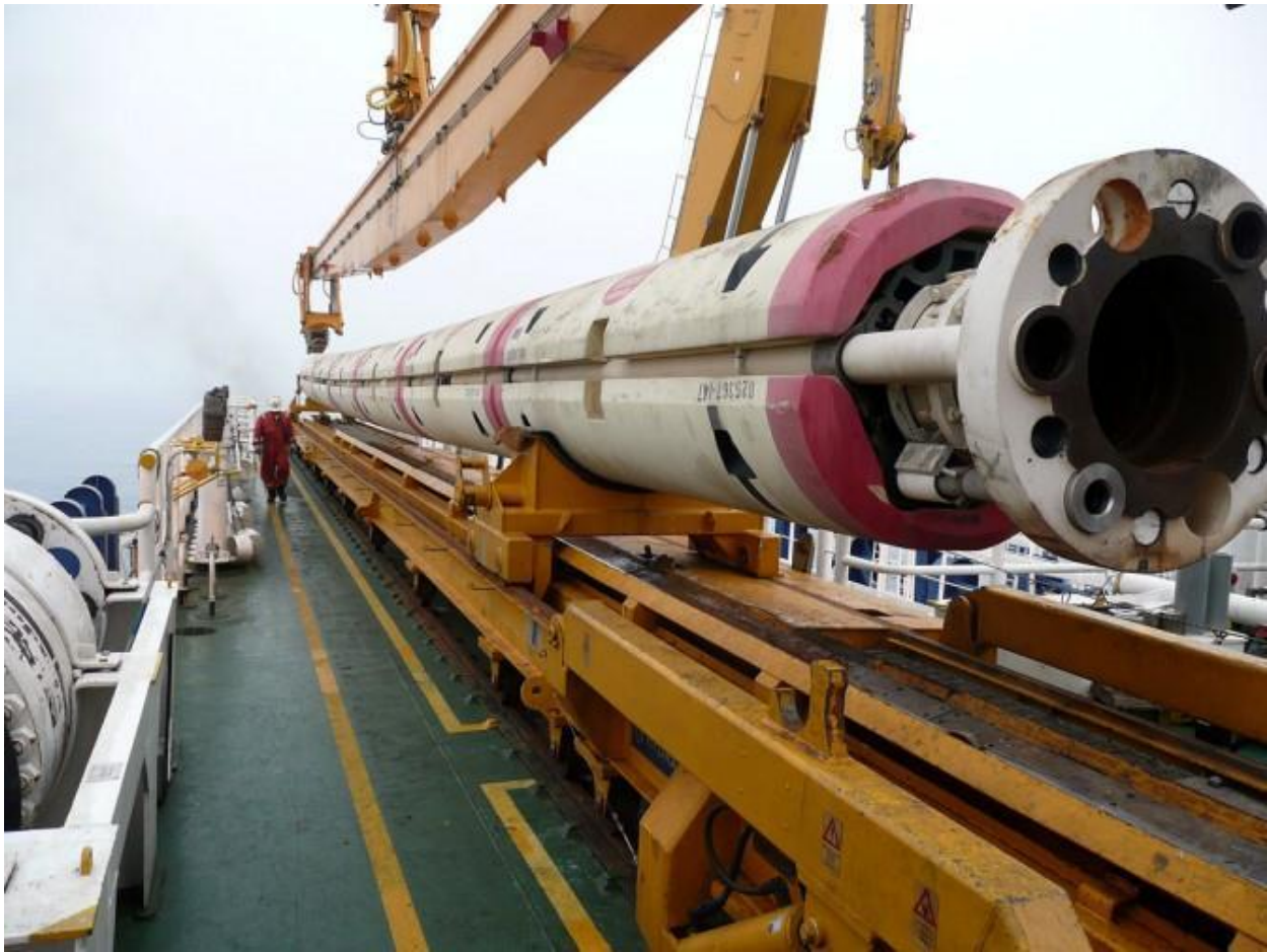
Figura 53. Tubería marina vertical (Riser) (Montiel, 2013, pp.84 -124).
