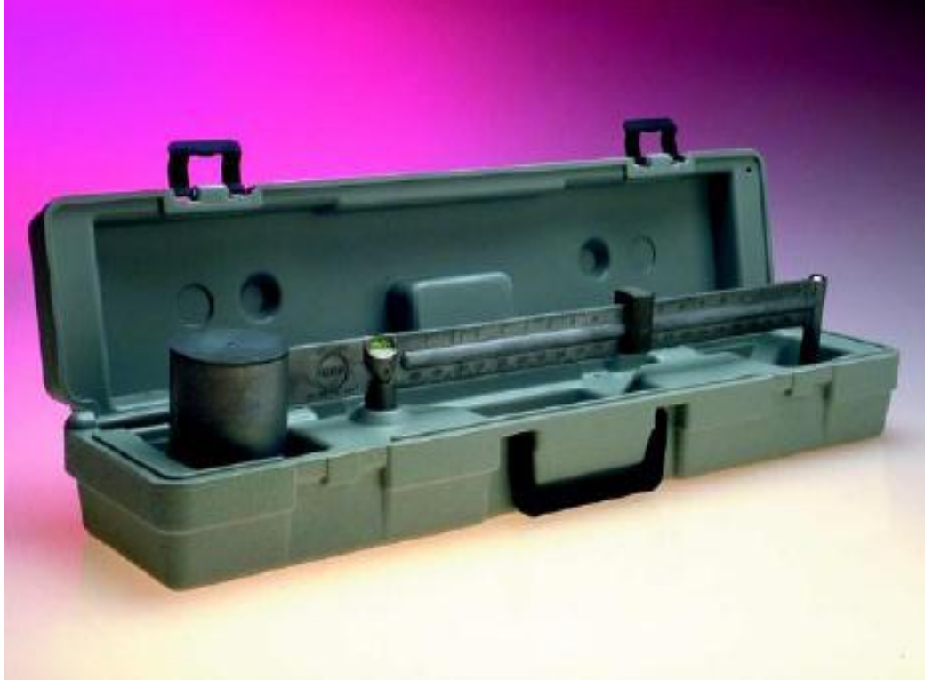
Figura 48. La balanza de lodos es un instrumento elemental para crear lodos de control con alta precisión (Montiel, 2013, pp.84 -124 ).
