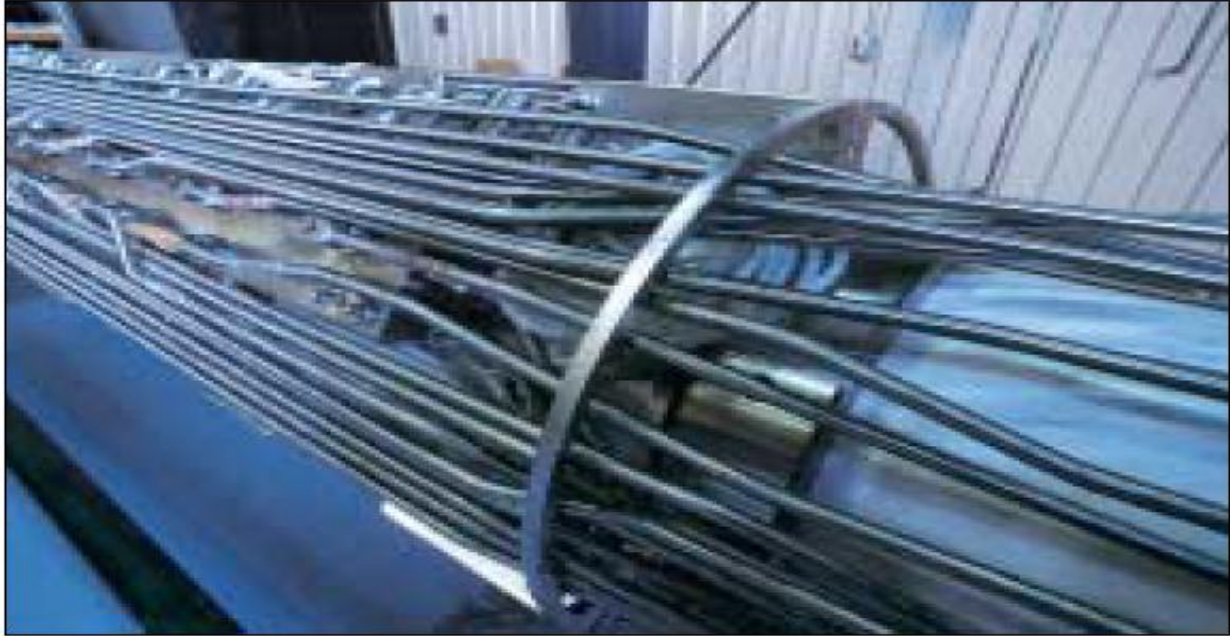
Figura 9. Dentro del sistema SenTREE7 las líneas hidráulicas transmiten las señales a las válvulas y a los conectores de la herramienta (Brandt et al., 1998, p.8).
