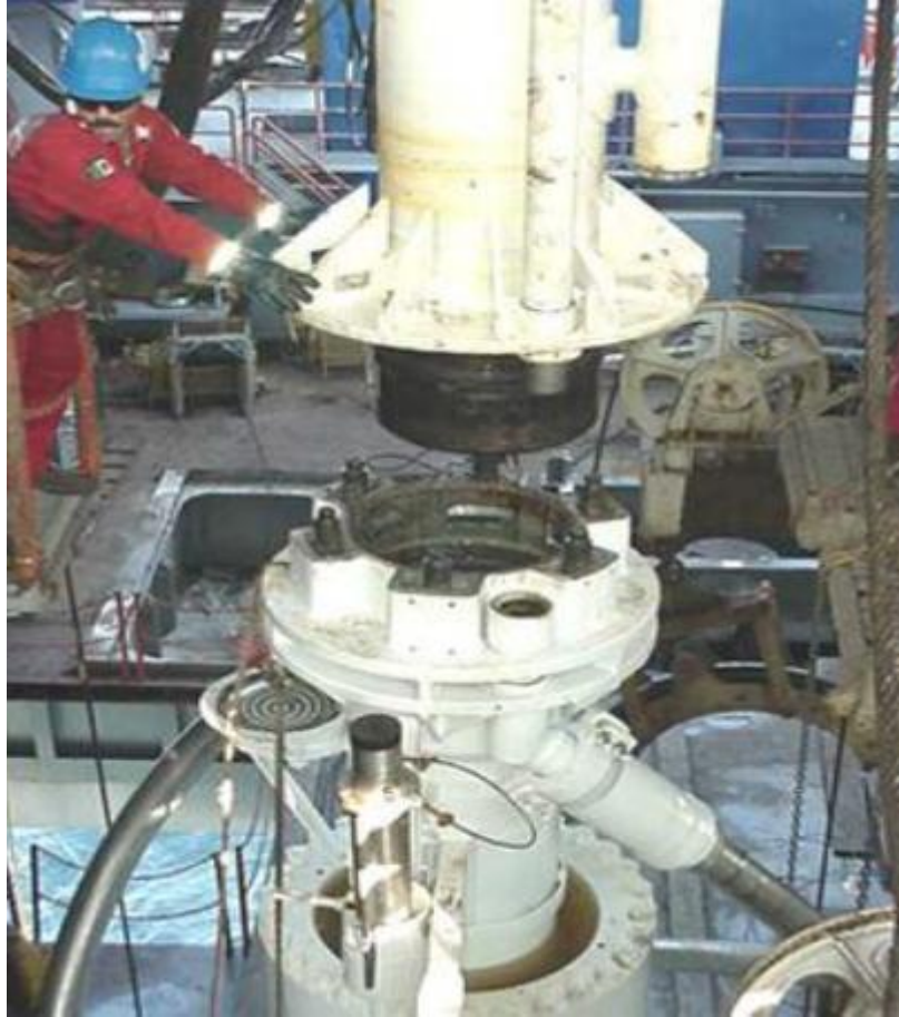
Figura 52. Conector del conductor marino (Montiel, 2013, pp.84 -124).
