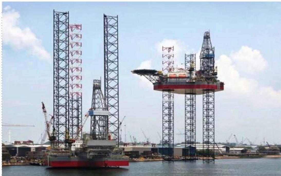
Figura 15. Plataforma de columnas plegables (Pérez & González, 2014, p.8).
