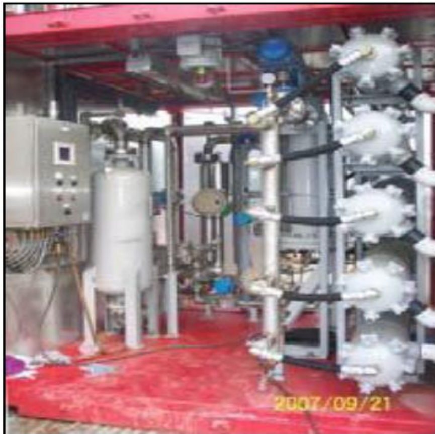
Figura 23. Membrana generadora de nitrógeno en sitio (NPU) (Sepúlveda, 2010, p.83).
