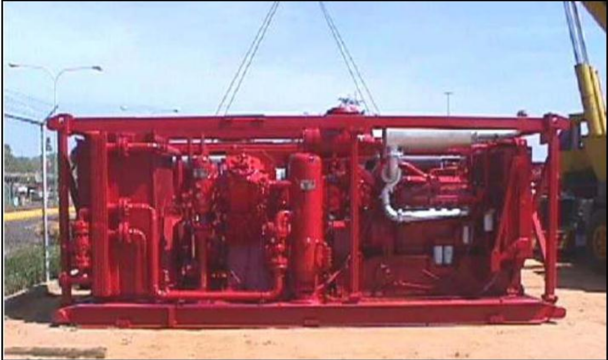
Figura 21. Compresor de pistón. (SEPÚLVEDA, 2010, p.80)
