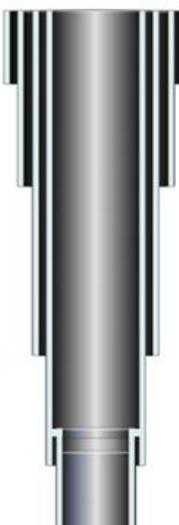
**Figura 4. Ejemplo de geometría de un pozo de petróleos.**
