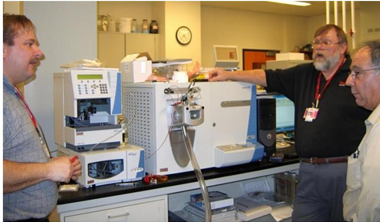
**Figura 53. Un instrumento de trampa de iones lineal de cromatografía líquida como ejemplo de un dispositivo que puede interactuar con un CDS (Sistema de datos de cromatografía).**
