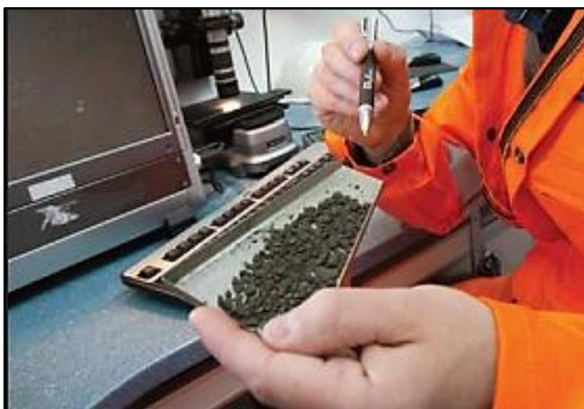
**Figura 65. Limpieza de muestra de cortes de perforación de lutita. Para su posterior análisis, evitando posibles datos erróneos en la interpretación de los cortes de perforación.**
