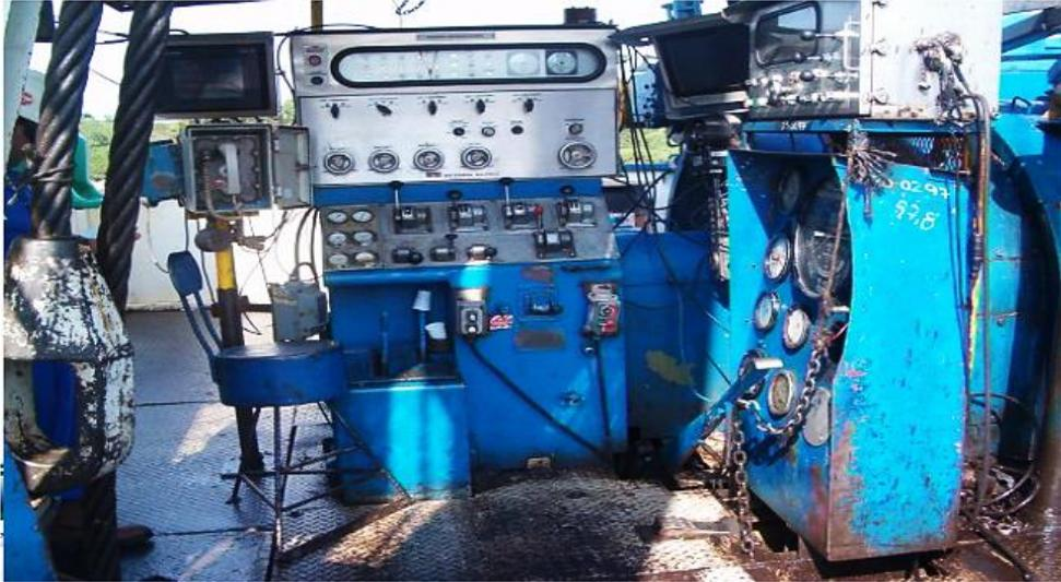
**Figura 54. WellWizard. Instrumento de monitoreo básico en el piso de la perforación.**
