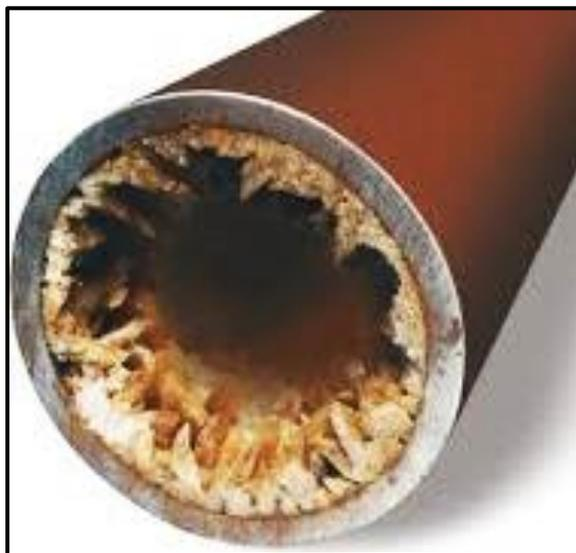
**Figura 71. Incrustación de CO<sub>2</sub> en tubería de producción.**
