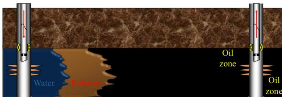
Figura 11. Esquema inyección de polímeros.
