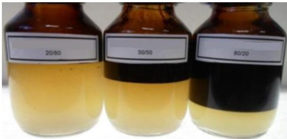
*Figura 16 Ejemplo de rompimiento total de la emulsión en las 3 proporciones planteadas en la prueba de compatibilidad*
