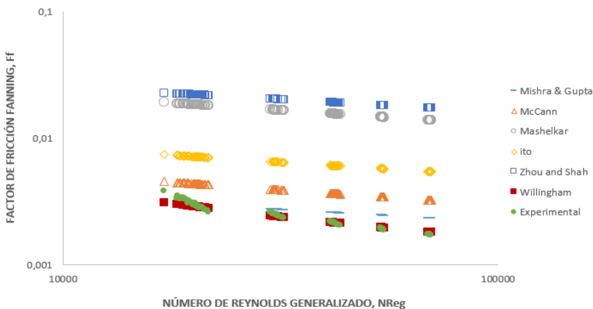
Figura 27. Factor de fricción vs número de Reynolds generalizado en tubería enrollada a 1500 ft de 1 in para guar a 20 lbm/Mgal, en régimen turbulento. ( a/R = 0.0112 ).
