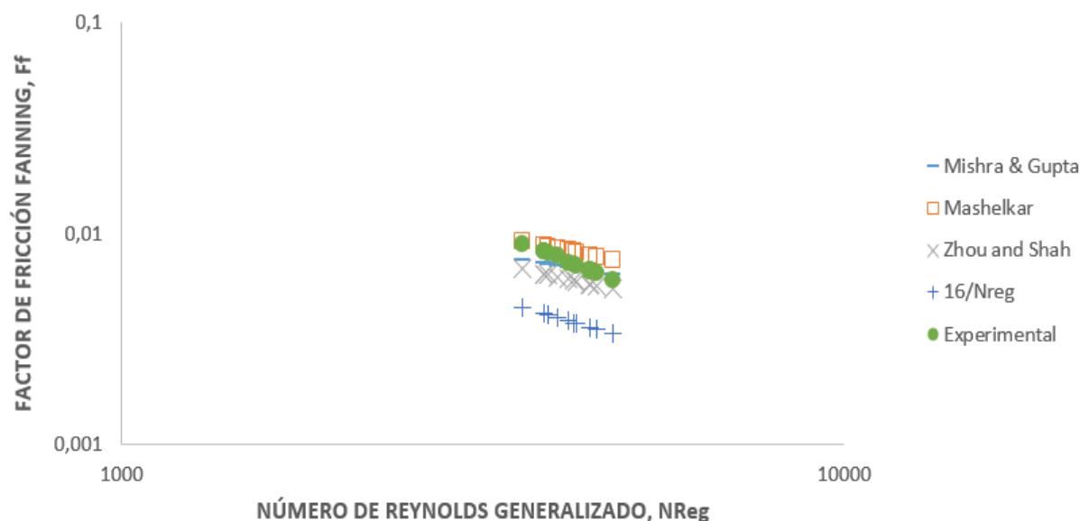
Figura 37. Factor de fricción vs número de Reynolds generalizado en tubería enrollada a 3000 ft de 1.5 in para guar a 40 lbm/Mgal, en régimen laminar. ( a/R = 0.0160 ).
