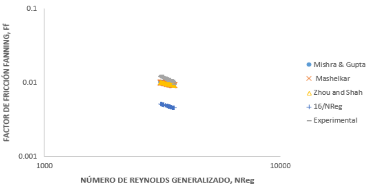
Figura 29. Factor de fricción vs número de Reynolds generalizado en tubería enrollada a 3000 ft de 2.375 in para guar a 20 lbm/Mgal, en régimen laminar. ( a/R = 0.0187 ).
