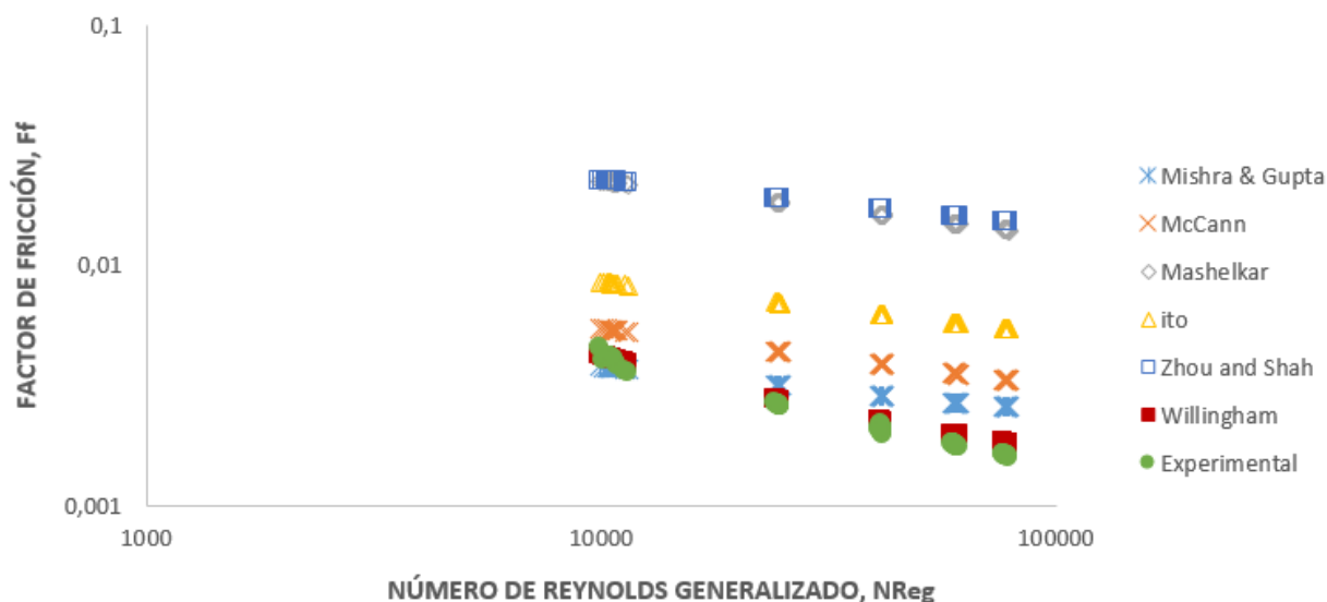
Figura 28. Factor de fricción vs número de Reynolds generalizado en tubería enrollada a 3000 ft de 1.5 in para guar a 20 lbm/Mgal, en régimen turbulento. ( a/R = 0.0160 ).
