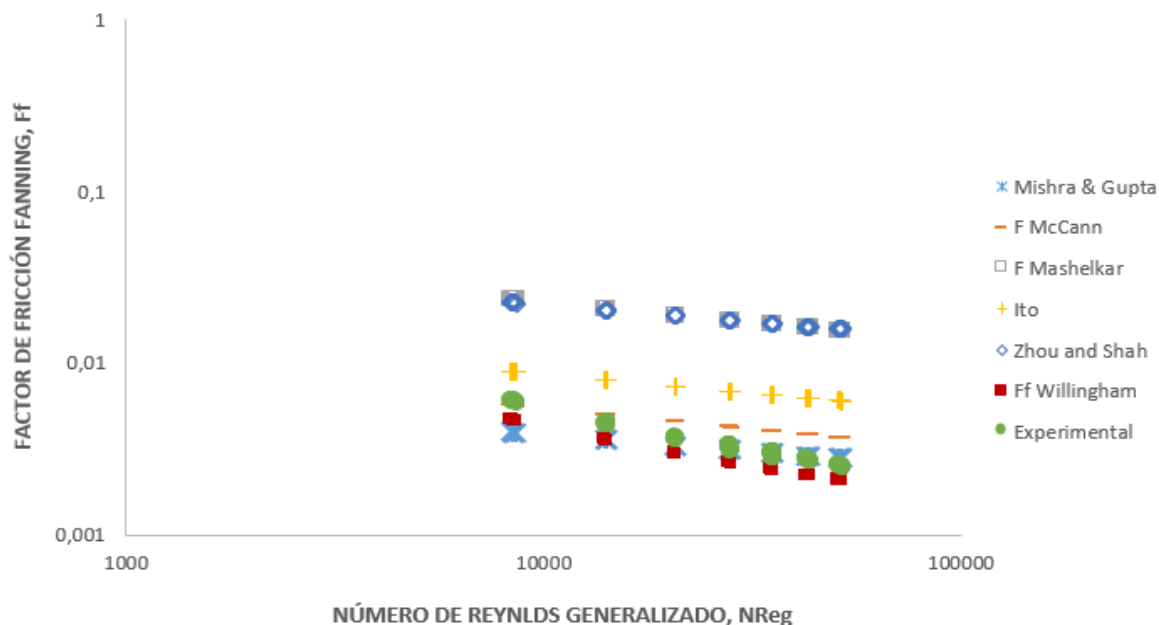
Figura 30. Factor de fricción vs número de Reynolds generalizado en tubería enrollada a 3000 ft de 2.375 in para guar a 20 lbm/Mgal, en régimen turbulento. ( a/R = 0.0187 )
