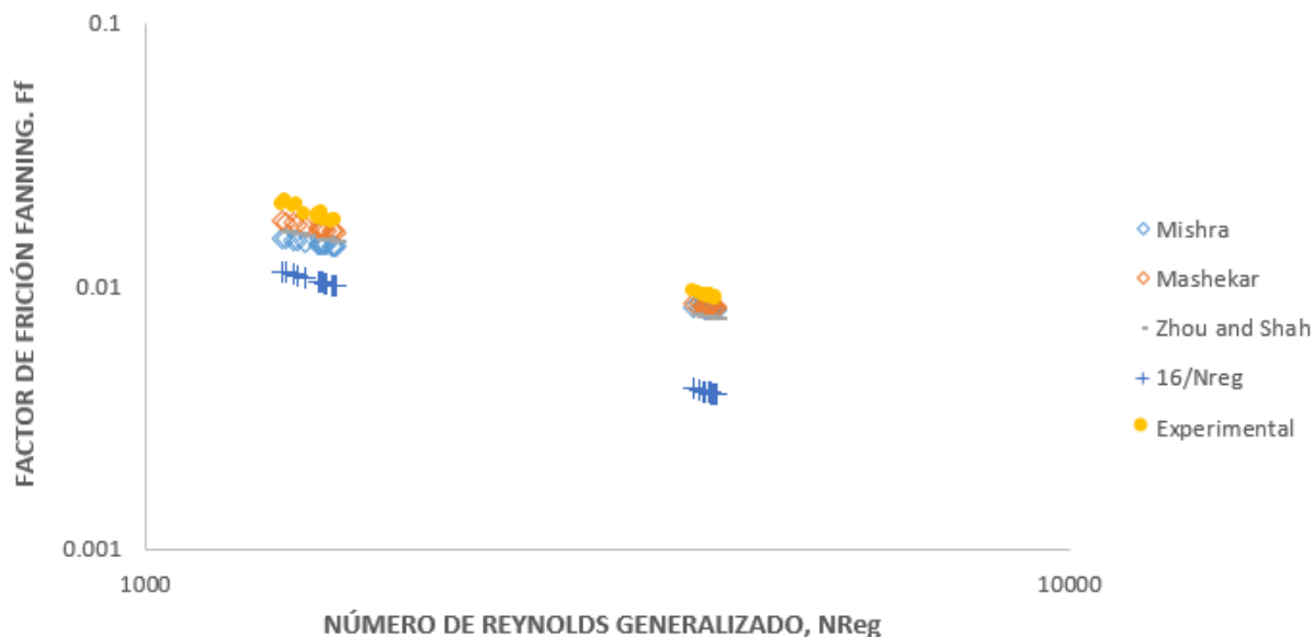
Figura 34. Factor de fricción vs número de Reynolds generalizado en tubería enrollada de 2.375 in, a 3000 ft para guar a 30 lbm/Mgal, en régimen laminar ( a/R = 0.0187 ).
