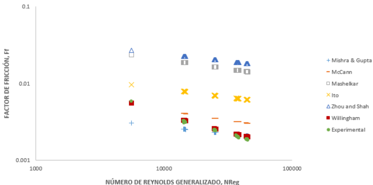
Figura 33. Factor de fricción vs número de Reynolds generalizado en tubería enrollada de 1.5 in, a 3000 ft para guar a 30 lbm/Mgal, en régimen Turbulento ( a/R = 0.0164 ).
