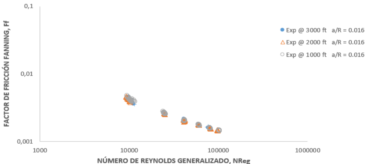
Figura 26. Factor de fricción vs número de Reynolds generalizado en tubería enrollada de 1 in para guar a 20 lbm/Mgal a 1000 ft, 2000 ft y 3000 ft. ( a/R = 0.016 )
