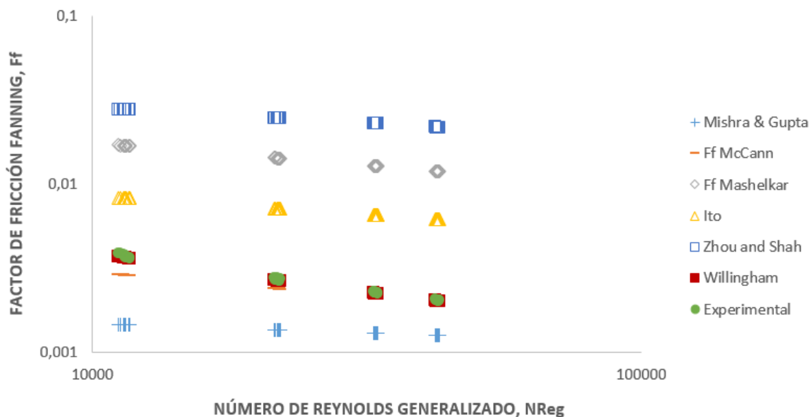
Figura 38. Factor de fricción vs número de Reynolds generalizado en tubería enrollada a 3000 ft de 1.5 in para guar a 40 lbm/Mgal, en régimen turbulento. ( a/R = 0.0160 )
