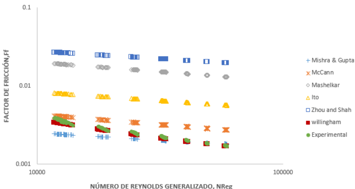
Figura 31. Factor de fricción vs número de Reynolds generalizado en tubería enrollada de 1 in a 1500 ft para guar a 30 lbm/Mgal, en régimen turbulento ( a/R = 0.01125 ).
