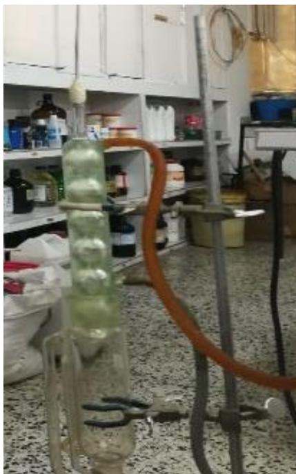
*Ilustración 15. Condensador de espiral.*
