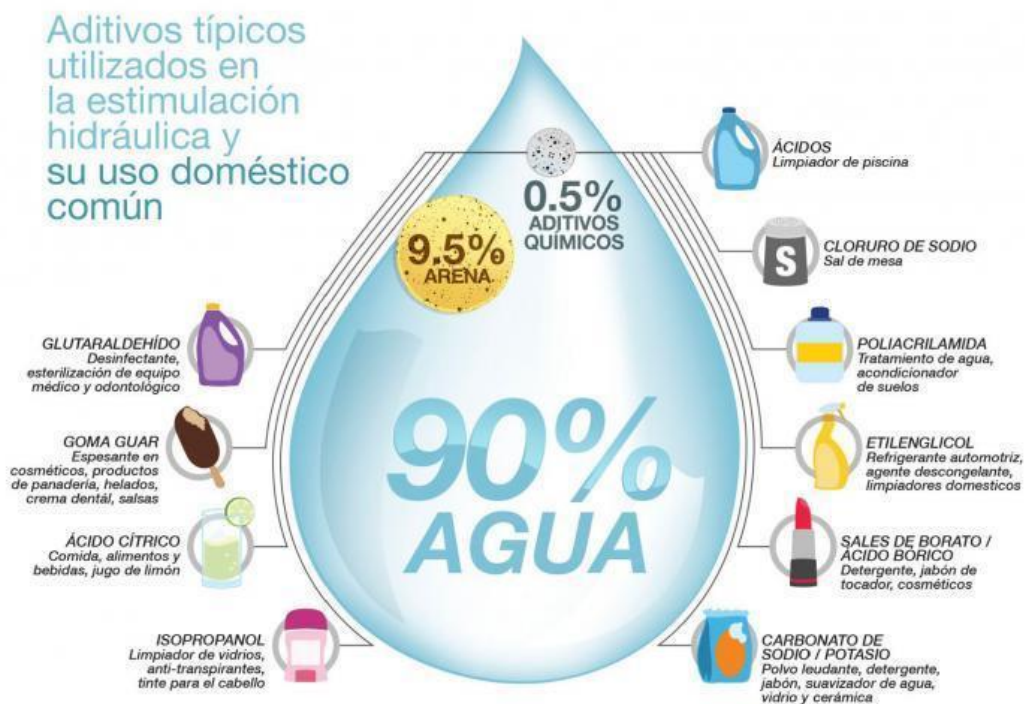
Ilustración 11. Aditivos típicos utilizados en la estimulación hidráulica y su uso doméstico común. Fuente: (ACP, 2017)
