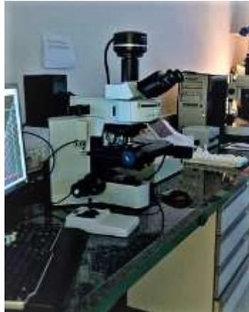
*Figura 2. Microscopio de luz transmitida y polarizada OLYMPUS BX5*
