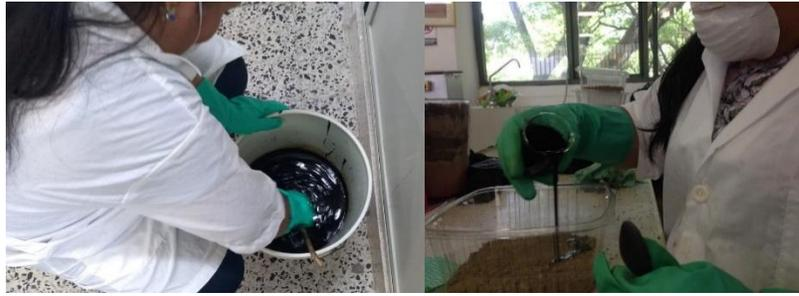
Seguidamente, se procede a pesar los gramos a utilizar en cada una de las Eras del producto a evaluar (Figura 9), ECH-encapsulador de hidrocarburos, luego se distribuye en las cajetillas con el suelo contaminado según corresponde (Figura 10), para terminar de preparar las muestras, se mezclan uniformemente formando una mezcla homogénea, según lo indica la aplicación de este producto.
