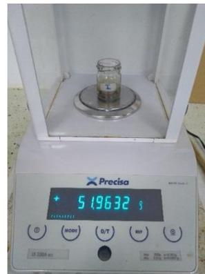
Conociendo los pesos y volúmenes empleados de solvente y el volumen final de la mezcla se puede determinar la cantidad de hidrocarburos totales de petróleo (TPH) presentes en el suelo.
