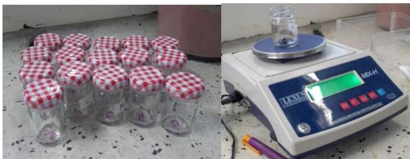
Una vez realizada la recolección de muestra, se traslada al laboratorio de Crudos y Derivados de la Universidad Surcolombiana, para determinar los TPH (hidrocarburos totales de petróleo) presentes, por medio del método gravimétrico modificado (extracción con solvente). (BERMEO CRUZ & PEREZ HUEJE, 2017)
