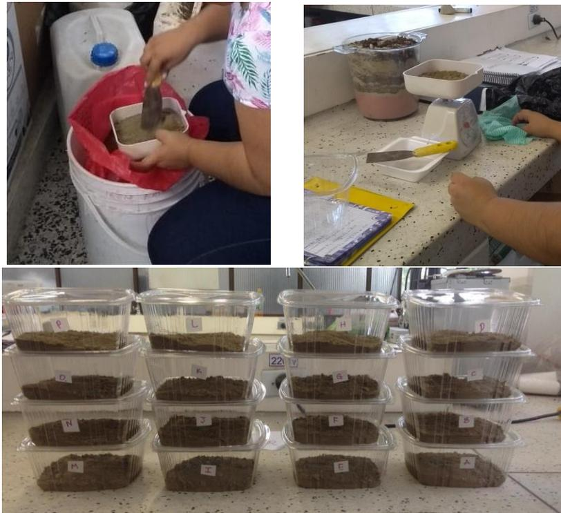
Luego, se mezcla la borra (Figura 8) con el fin de homogenizarla y garantizar que esta sea distribuida uniformemente en cada una de las cajetillas que ya tienen el suelo que se dispone a contaminar.
