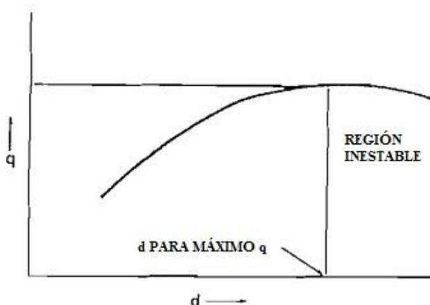
**Figura 10** Elección del diámetro óptimo de la tubería de producción (Beggs D. , 2003).
