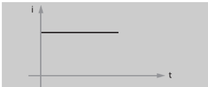
Figura 3. Esquema de corriente continua. Fuente: Mendoza 2002
