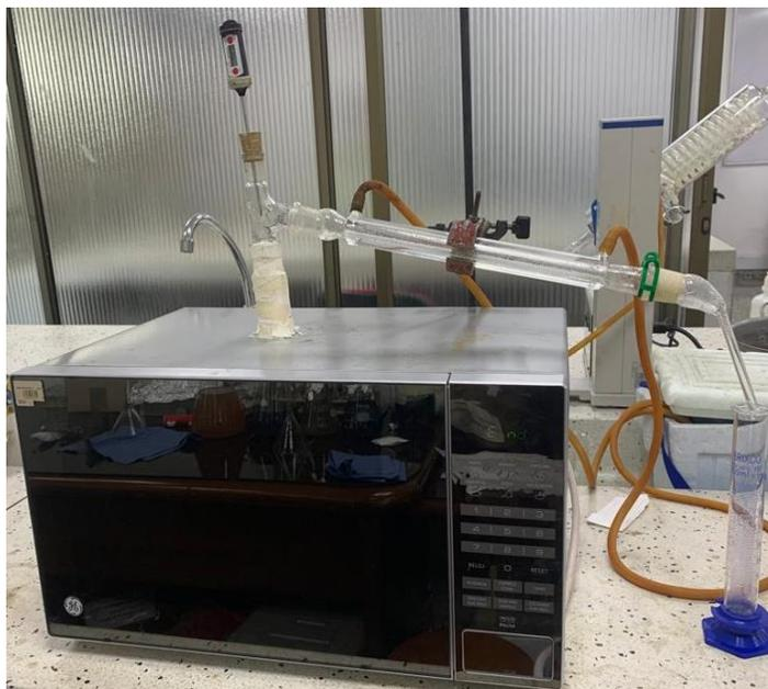
Ilustración N° 12 Montaje para la hidrodestilación simple asistida con microondas.
