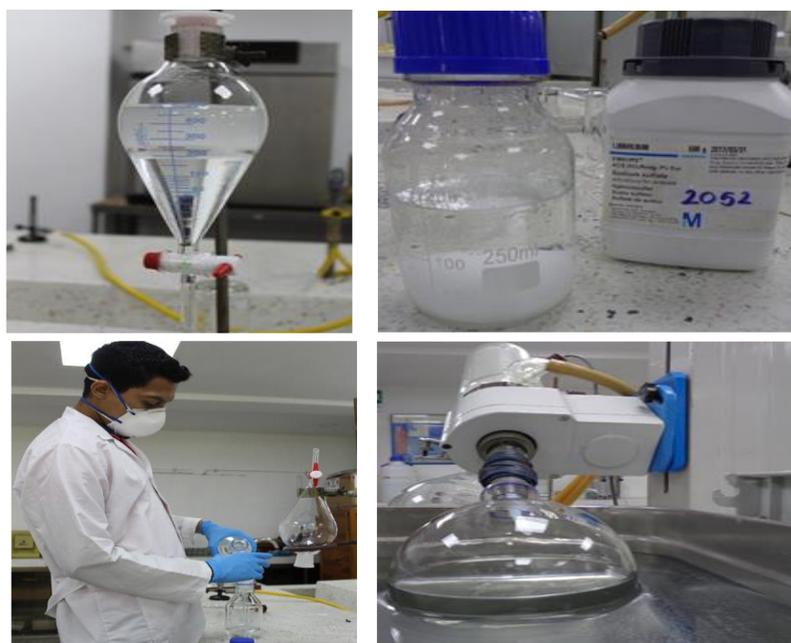
Ilustración N° 10 Montaje extracción líquido-líquido, secado de fase orgánica y rotoevaporación. Tomada de: Ríos y Rojas, (2017).
