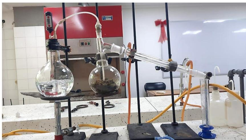
Ilustración N° 11 Montaje experimental para la obtención del AE por medio del método de SD.
