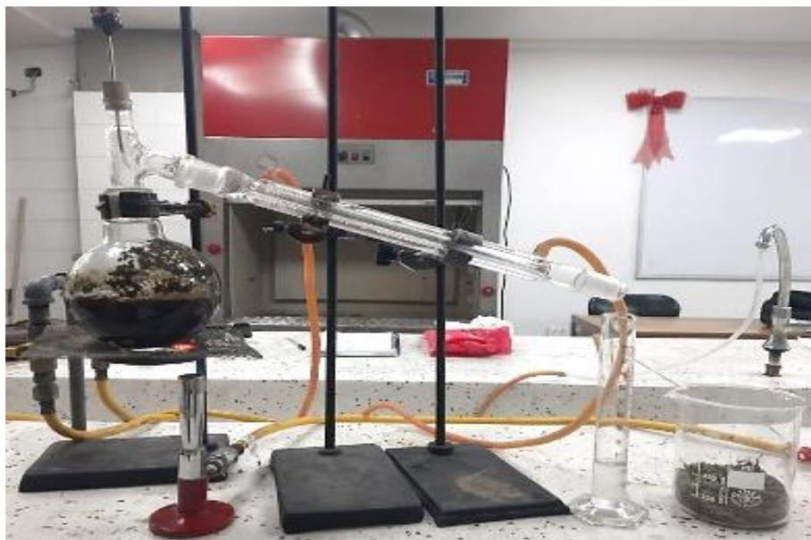
Ilustración N° 9 Montaje experimental para la obtención de AE por medio del método de HD.
