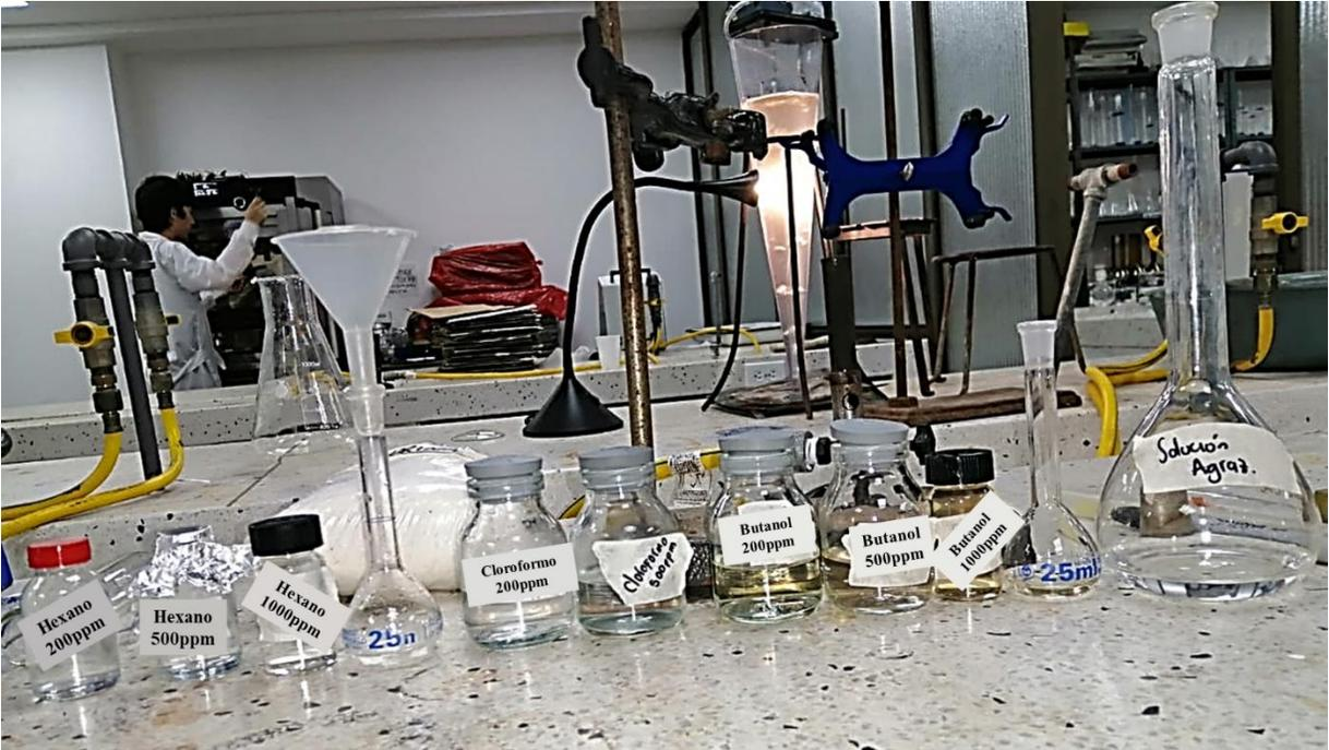
*Figura 37. Preparación de cada solución del extracto a diferentes concentraciones por ppm.*
