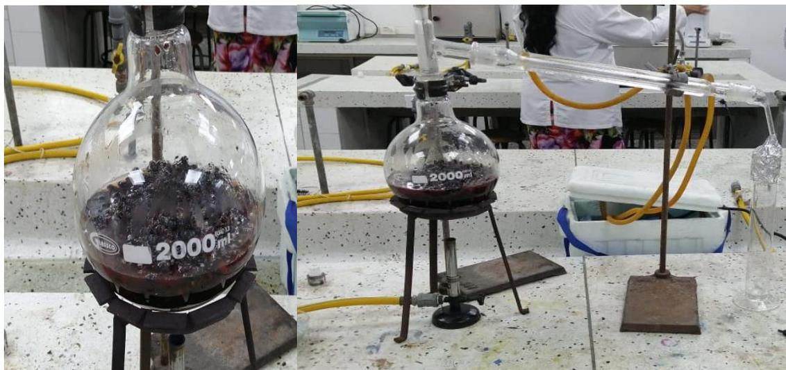
*Figura 45. Montaje para la hidroddestilación simple de las semillas de la Vitis tiliifolia.*
