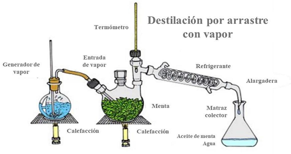
**Figura 22.** Destilación por arrastre de vapor para la obtención de aceites esenciales. Tomado de (Girbes, et al., 2008)
