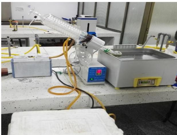
*Figura 26. Rotaevaporación de los extractos*
