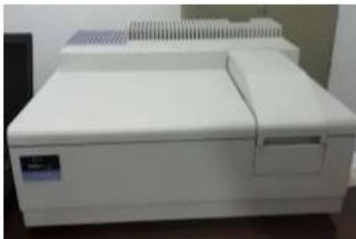
*Figura 34. Equipo UV/VIS, serie 502508121003, modelo Perkin Elmer Lambda 35 del laboratorio de Química de la Universidad Surcolombiana. Tomada de (Giraldo, et al., 2019)*
