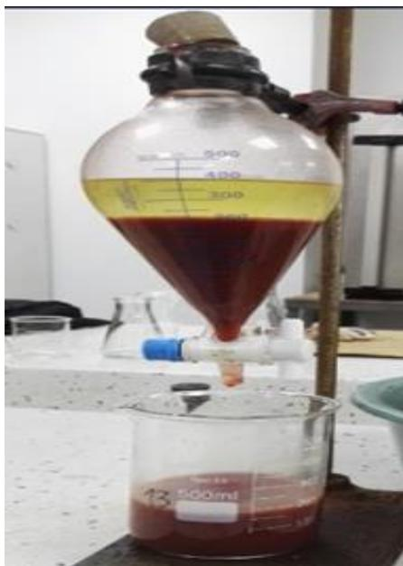
*Figura 25. Mezclado del zumo del Agraz con el disolvente orgánico (Hexano, Cloroformo y Butanol)*
