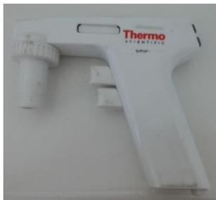
Gráfica 35. Pipeteador de Thermo Scientific. Serial N° 96060, power input: 6V; 0,5A.
