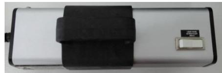
Gráfica 42. Lámpara de Luz U.V. de Aqualab. Model EA-160. 365 nm. 115 Volts. 60 Hz. 0.20 Amps. Serial N° 1847063.
