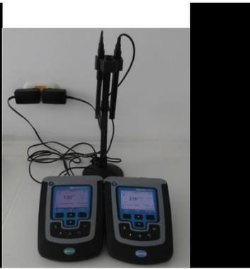
Gráfica 30. pH-metro HQ 411d pH/mV de HACH y Medidor multiparámetro HQ440d multi de HACH.
