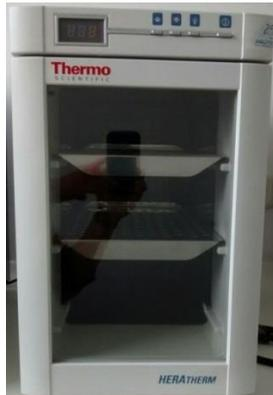
Gráfica 41. Incubadora de Thermo Scientific. Type Heratherm IMC 18. Serial N° IMC 40470363. 17-40°C. 50/60 Hz. 1N/PE 100-240V 0.85A.
