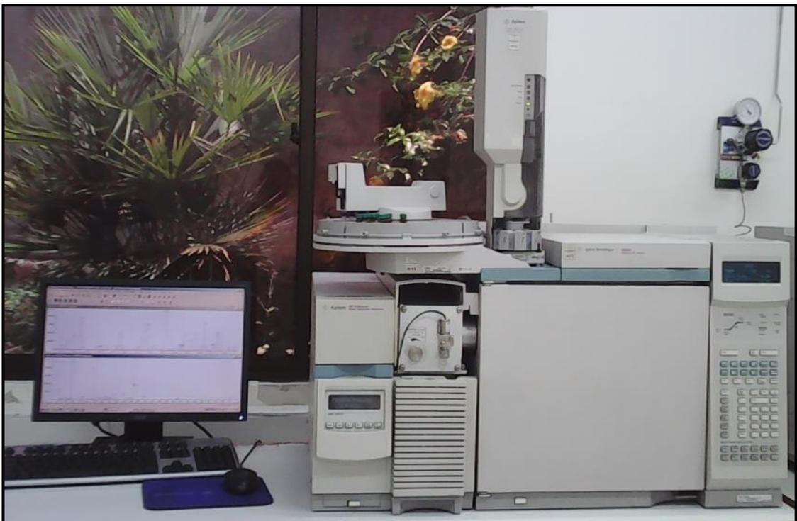
Imagen No. 18. Cromatógrafo de gases acoplado a masas del laboratorio de medicina legal.
