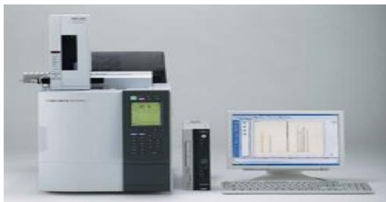
IMAGEN No 1. CROMATOGRAFO DE GASES
