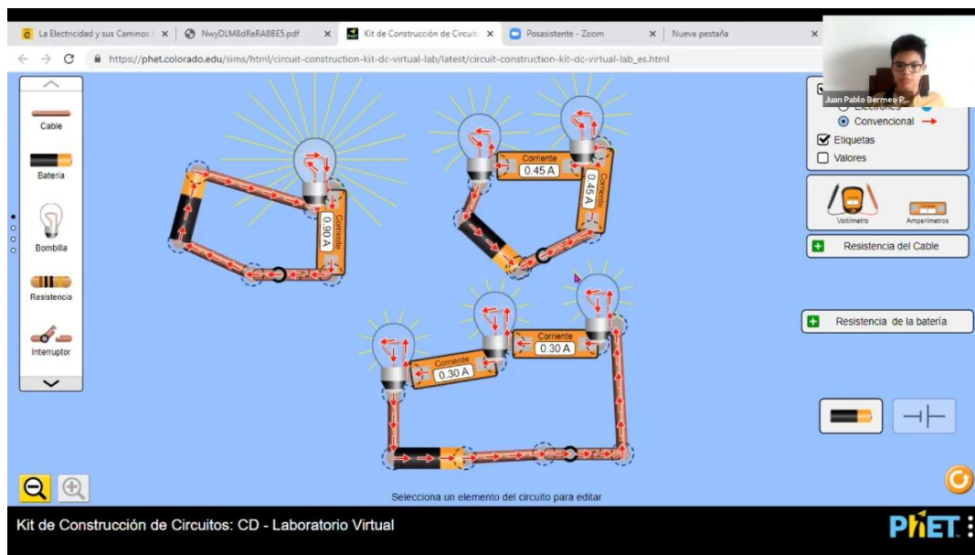
Figura 20. Construcción de Circuitos en el Simulador PHET
