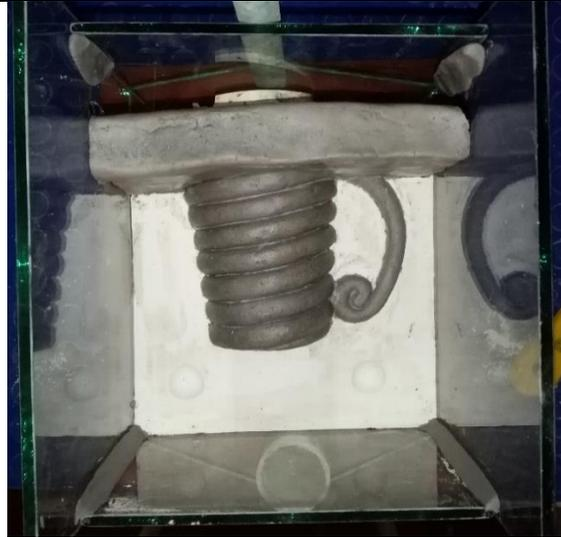
3. Se acomodan verticalmente los dos primeros taceles donde se siguió con la culminación del tercero después de volver a hacer otros hoyos de retención de movimiento, la aplicación del antiadherente y la instalación del tubo de PVC de 3 pulgadas para la entrada del vertido de la barbotina.
