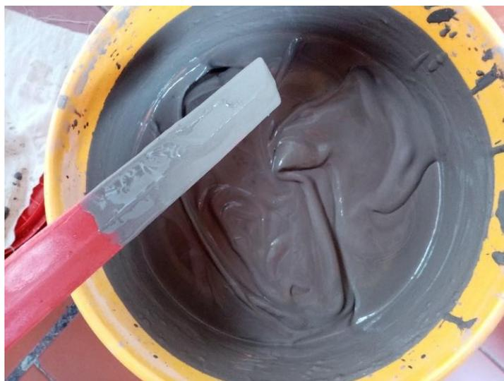
Sin embargo, al dejar en reposo deja de tener un espesor similar al de un pudin para alcanzar una consistencia gelatinosa. Dando la probabilidad de ineficacia en el ensayo vertiéndola en los moldes.
