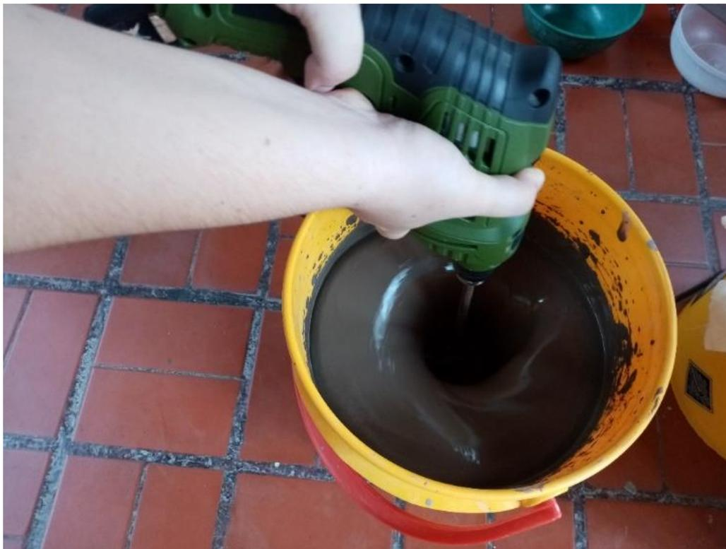
Después 24 horas de reposo, se ejecuta la prueba de la barbotina. Se vierte la mezcla en los moldes previamente hechos después de batirla para amenguar la gelatinización que adquiere en reposo y con ello hacerla lo más fluida o líquida. Aun así, al tacto deja una sensación demasadamente ligera a diferencia de otras barbotinas comerciales de las cuales ya se había palpado.
