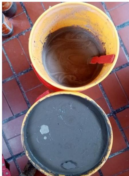
Al probar la mezcla en los moldes, se obtiene un rendimiento similar al de la fórmula de la etapa anterior en lo que se refiere a las cavidades cerradas de los moldes con la diferencia de que las piezas adquieren un mayor grosor, menor adherencia.
