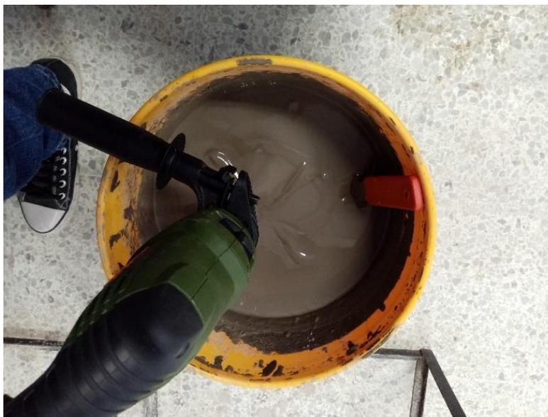
Se repitió el proceso de mezclar, más aún se veía con espesor. Así que, se le añadió  $\frac{1}{2}$  litro de agua de más resultando más aguada de lo esperada, puesto que por error no se dio tiempo de que todos los componentes se incorporaran homogéneamente. Por lo que se deduce que es necesario dejar en reposo por lo menos una media hora para dictaminar una nueva alteración en la fórmula y evitar la incorporación de elementos que rebosen en la composición como lo fue el exceso de agua.
