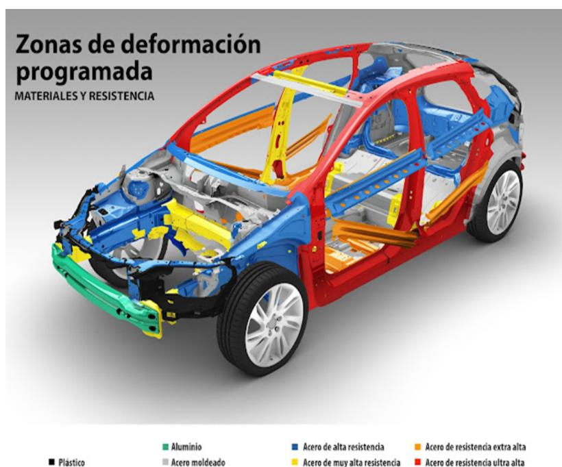
**Figura 1:** Clasificación del Acero en el Vehículo.
