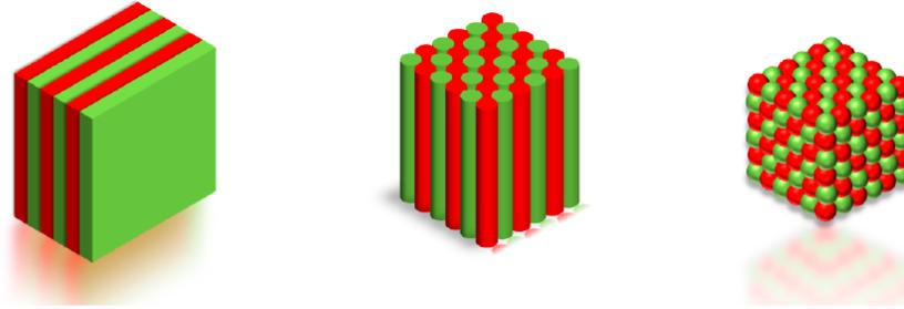
**Figura 2-1.:** Representación esquemática de un CF-1D, CF-2D y CF-3D. El color diferente representa materiales con diferentes constantes dieléctricas [41].
