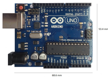
Figura 5.2: Arduino UNO R3 (Fuente: Cáceres & Charry, 2018)
