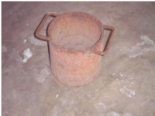
Figura 18 Anillo Infiltrómetro
