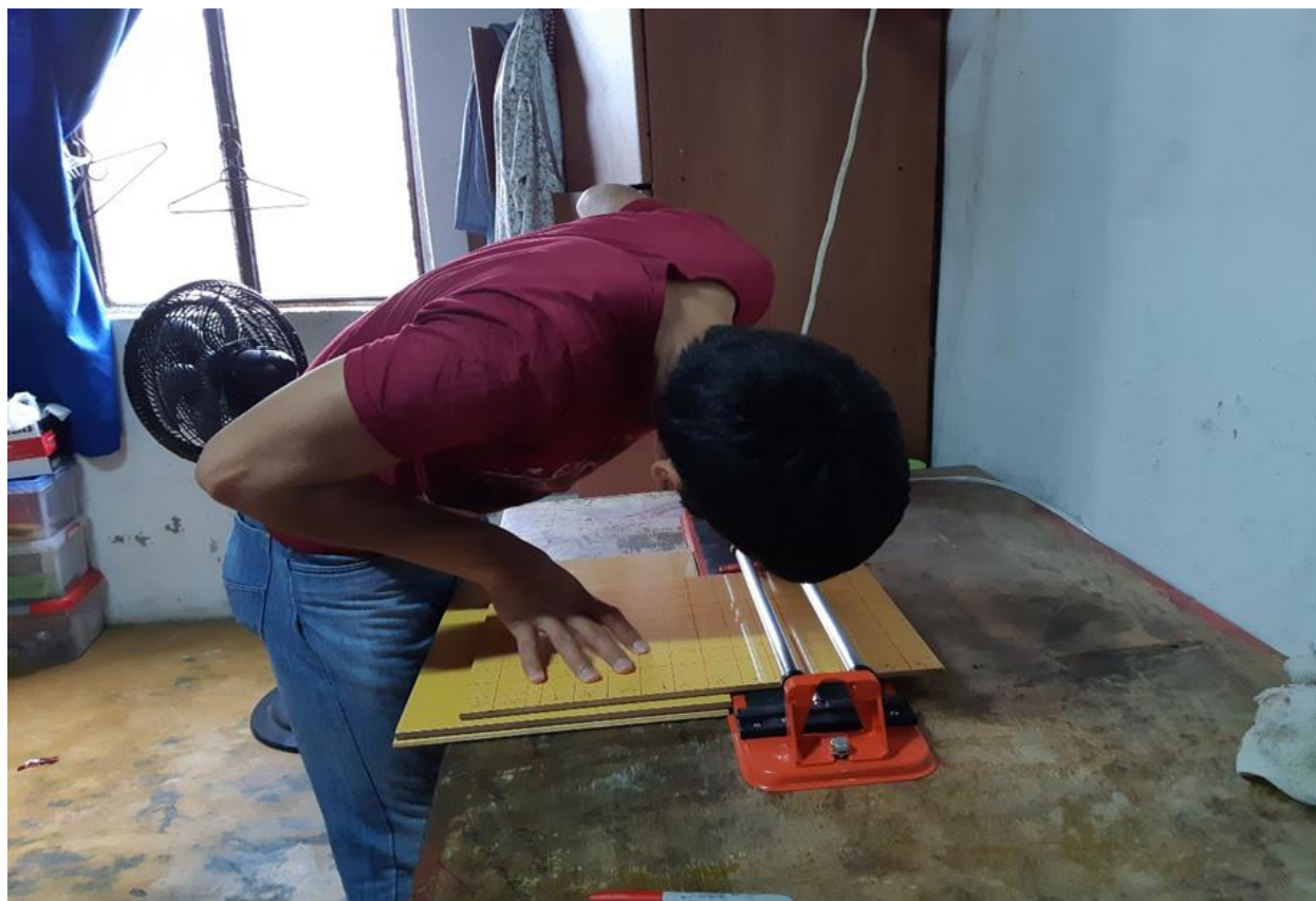
Fotografía 66 Corte de telas de 3 por 3 centímetros con cortadora de enchape
