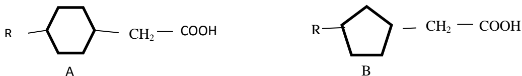
Figura 1. Ejemplos de estructura molecular de ácidos nafténicos. A: ácido ciclohexano acético. B: ácido ciclopentano acético.
