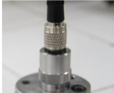
Figura 42. Transductor ultrasónico V318-SU marca Olympus.
