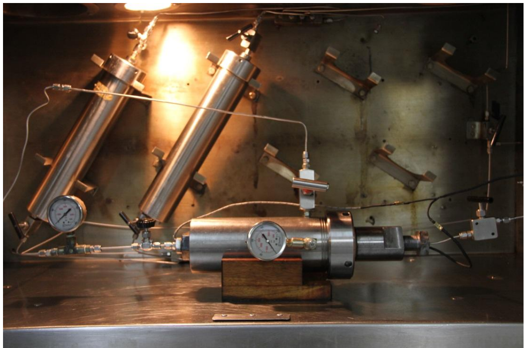
Figura 31. Sistema: Horno y Porta núcleos para resistividad
