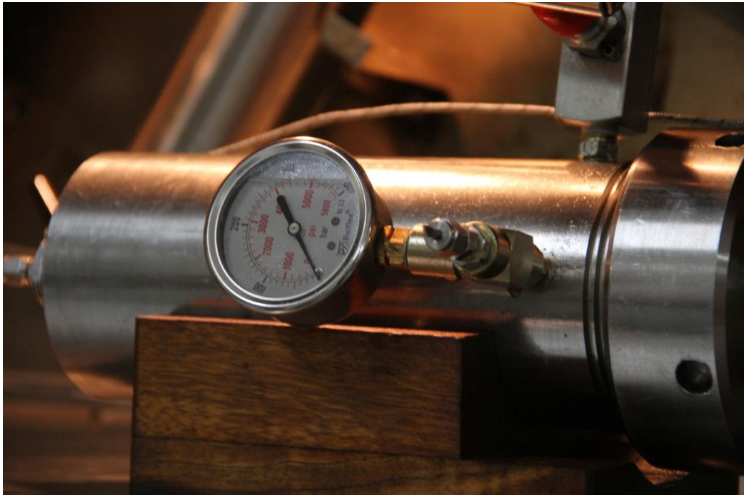
Figura 30. Porta núcleos para medir resistividad
