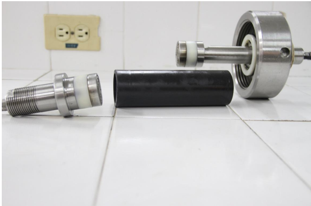
Figura 33. Conjunto de electrodos, manga de VITON y tapa
