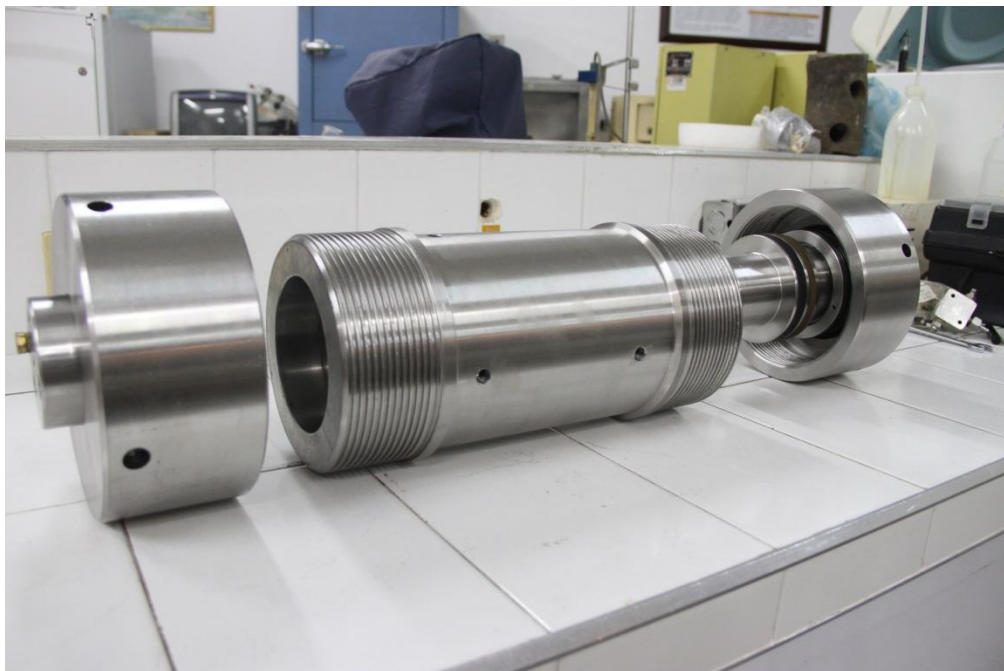
Figura 48. Componentes del porta núcleos para medir velocidad acústica
