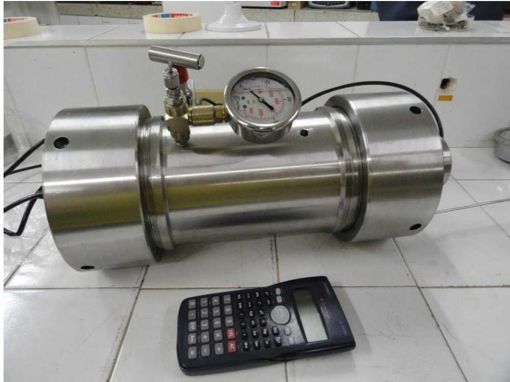
Figura 49. Porta núcleos para medir velocidad acústica ensamblado.
