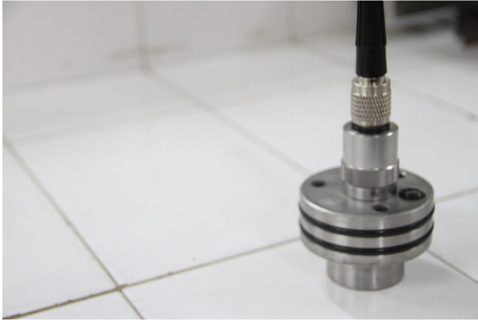
Figura 47. Transductor acústico (0,5 MHz) del porta núcleos para medir velocidad acústica
