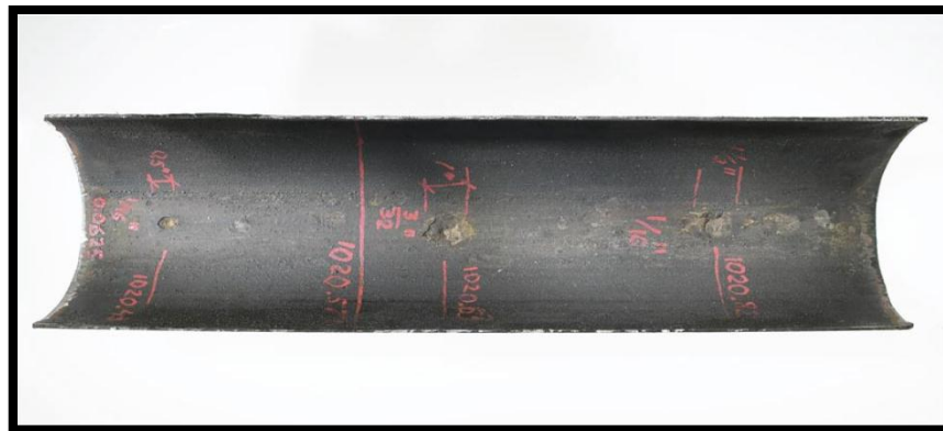
Figura 10. Picadura en tubería de producción.
