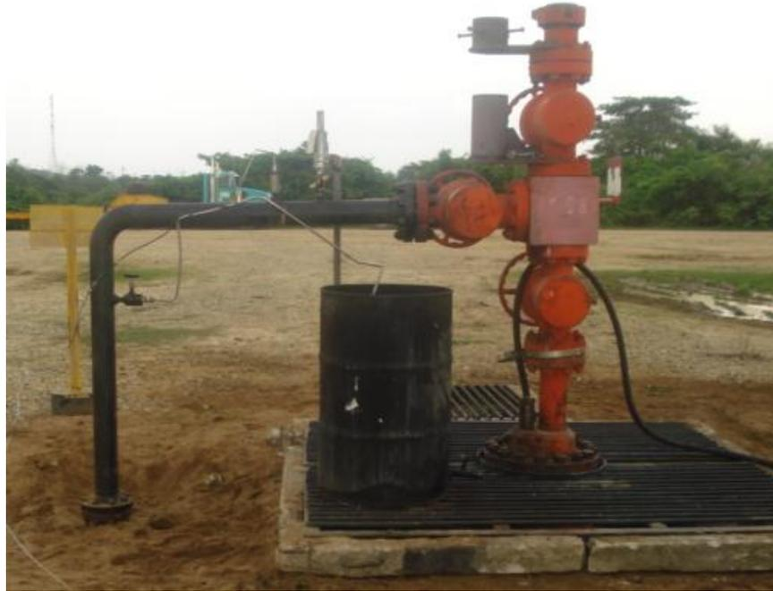
**Grafica 4. Cabezal de pozo con Bombeo Electrosumergible.**
