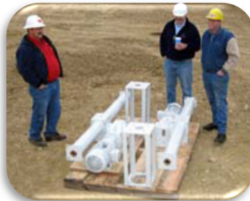
Figura 14. Bombeo Mecánico Lineal (fácil de transportar).
