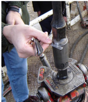
Figura 25. Control de contacto entre espejos (Pin/Box).
