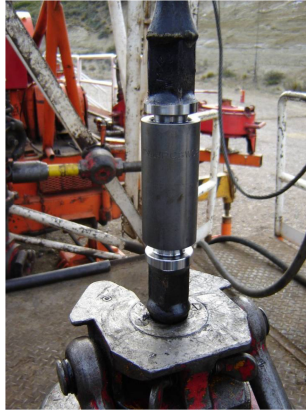
Figura 24. Posición de Ajuste a Mano (Hand-tight)
