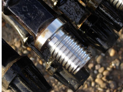
Figura 22. Limpieza de las roscas.
