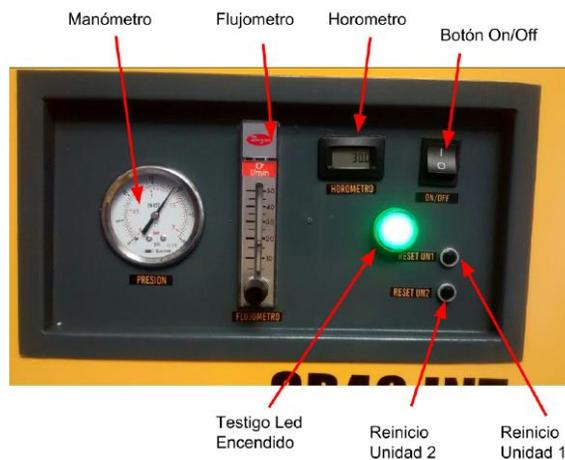
**Figura 27.** Partes Planta de oxígeno disuelto
