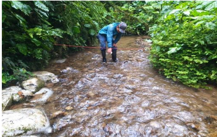
FIGURA 3: Realización del aforo por el método del flotador
