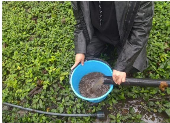
FIGURA 2: Aforo a través del método volumétrico
