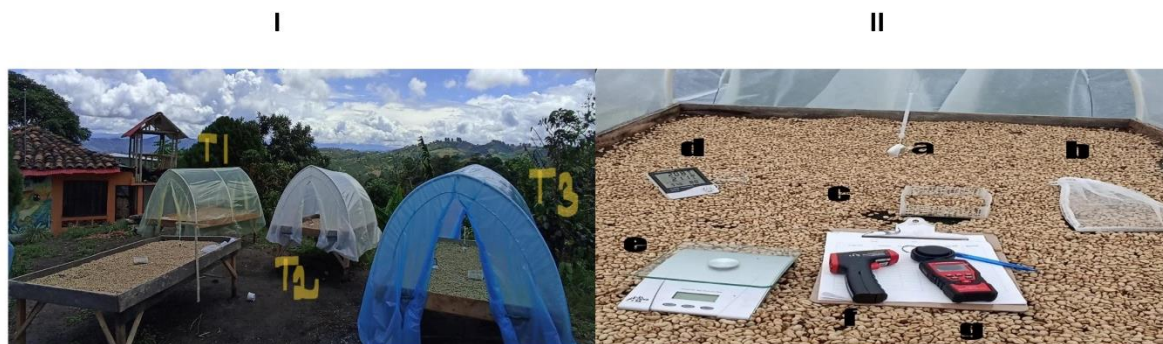
FIGURA 2. I) Montaje del experimento. II) Ubicación de los elementos de medición: a) sensor termohigrómetro, b) saco para control de pérdida de masa, c) canastilla plástica gravimet, d) Termohigrómetro digital, e) balanza gravimet, f) termómetro infrarrojo, g) luxómetro.
