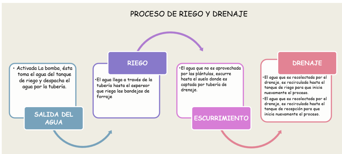
Diagrama 3. Proceso de riego y drenaje
