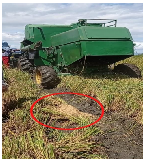
FIGURA 8. Pérdidas por fugas en la combinada.
