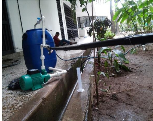
Figura 5. Determinación del Coeficiente de Variación y la curva de Presión – gasto del gotero tipo C.
