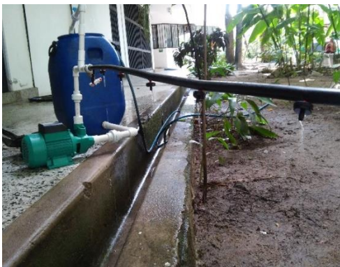
Figura 6. Determinación del Coeficiente de Variación y la curva de Presión – gasto del gotero tipo B.
