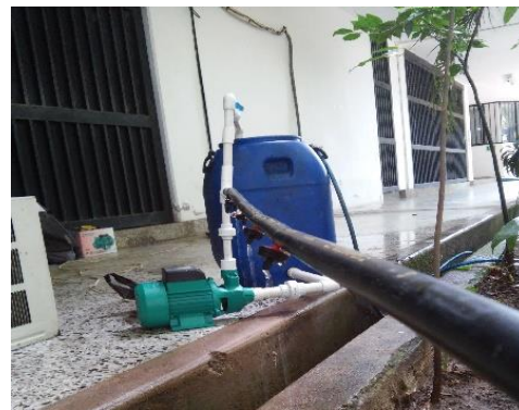
Figura 7. Determinación del Coeficiente de Variación y la curva de Presión – gasto del gotero tipo A.
