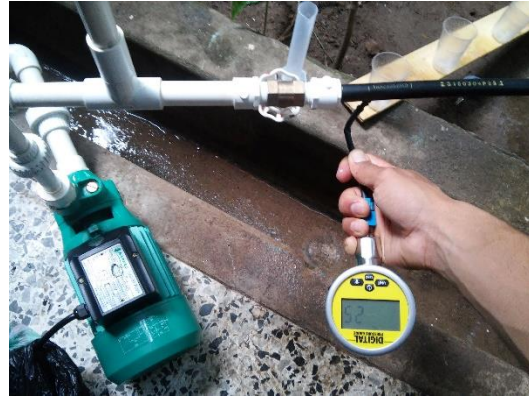
Figura 9. Calibración de presiones mayores a 15 PSI.
