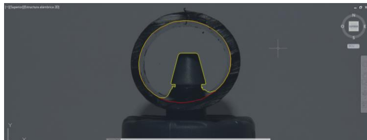
Figura 10. Digitalización de las áreas del sistema tubería – gotero mediante el software AutoCAD 2016 versión estudiante.
