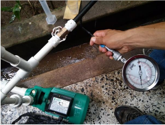
Figura 8. Calibración de presiones menores a 15 PSI.
