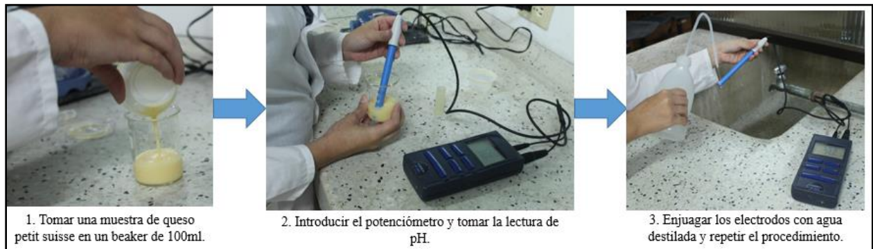
Figura 6 Proceso de toma de pH
