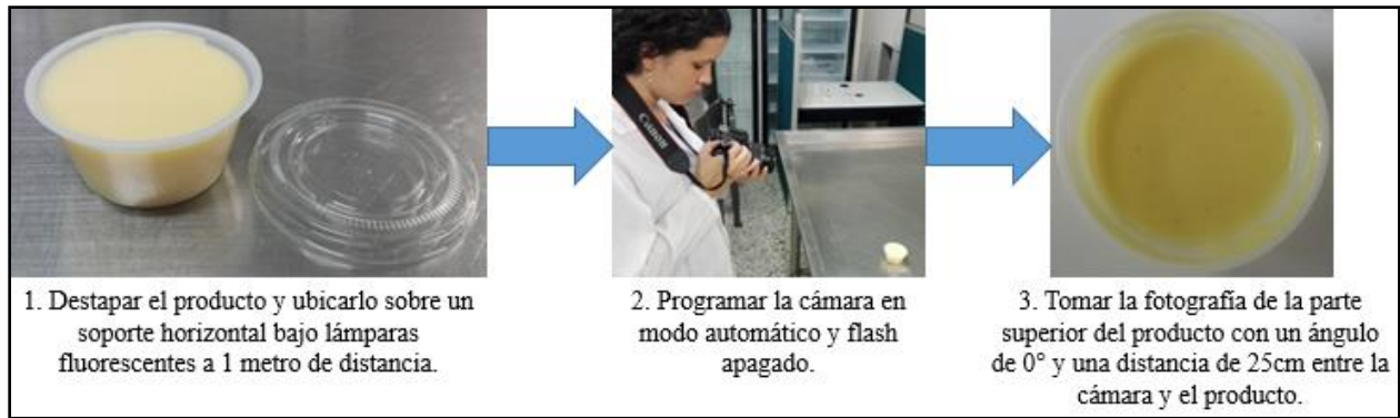
Figura 11 Procedimiento para la toma de Color
