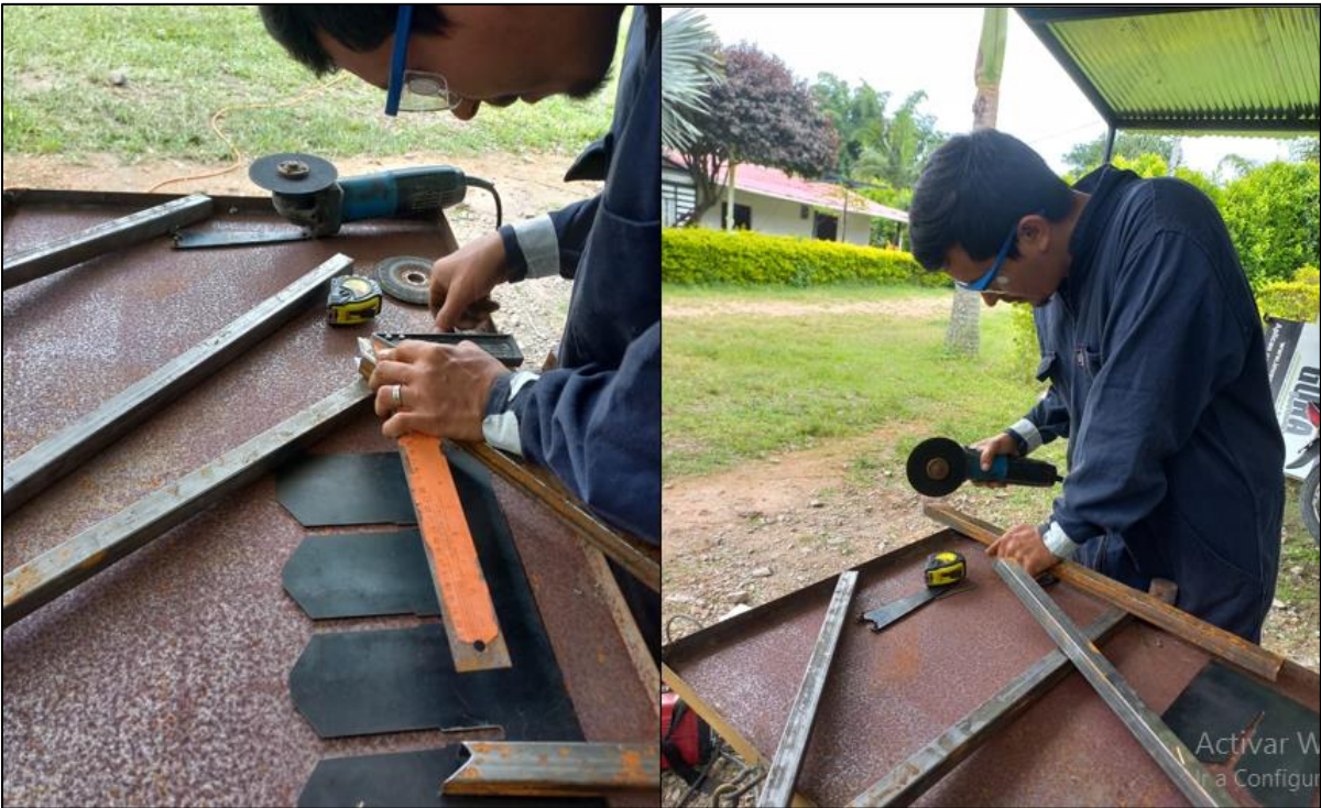
Medición y corte de los tubos de hierro para hacer la herramienta
