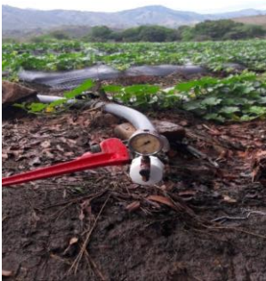
Anexo 5. Aforo de tubería secundaria, método volumétrico.
