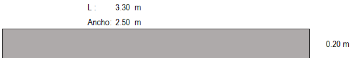
FIGURA 11. Diagrama esquemático de la losa: dimensiones generales.
