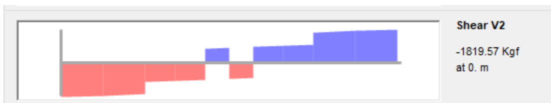
FIGURA 24. Resultado del modelado sap2000 de la viga: Diseño a cortante.
