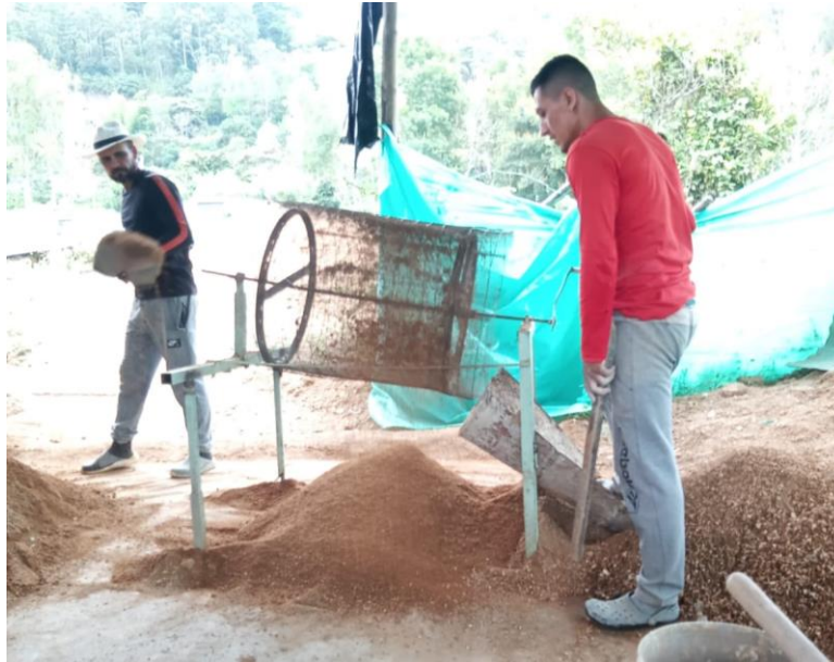
Figura 3-3: Proceso de zarandeo por malla acerada armada de manera cilíndrica.
