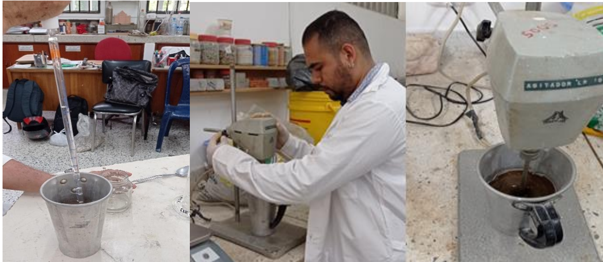
Figura 3-12: Aplicación de agente dispersante y agitación de muestras de Subsuelo en la copa de dispersión.
