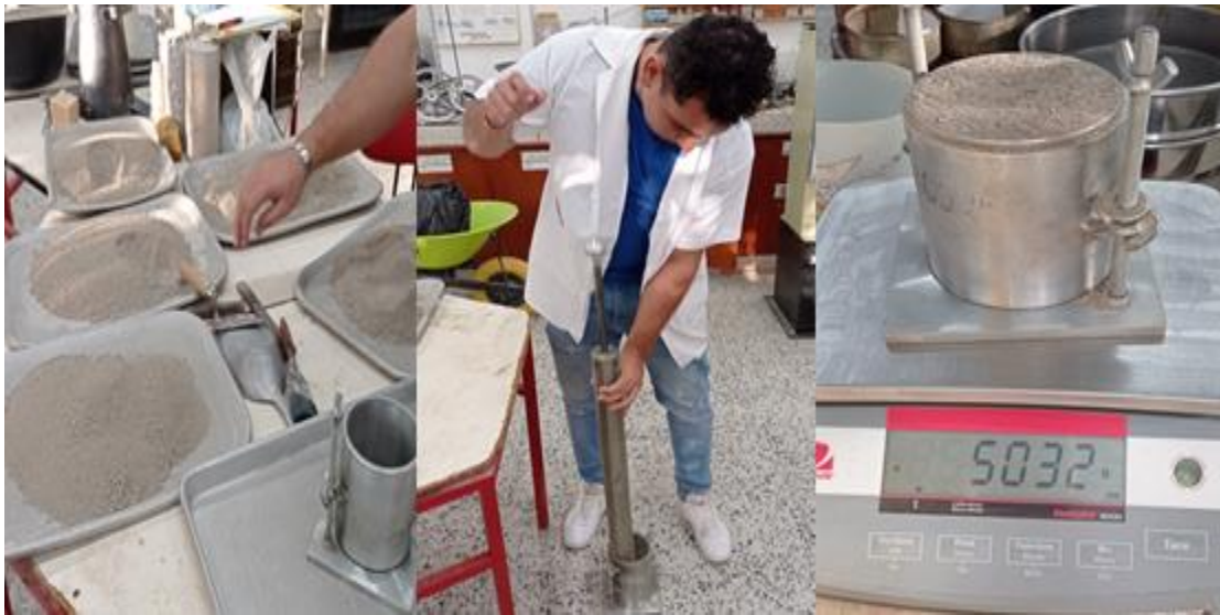
Figura 3-16: proceso de mezcla y compactación en el ensayo Proctor modificado.
