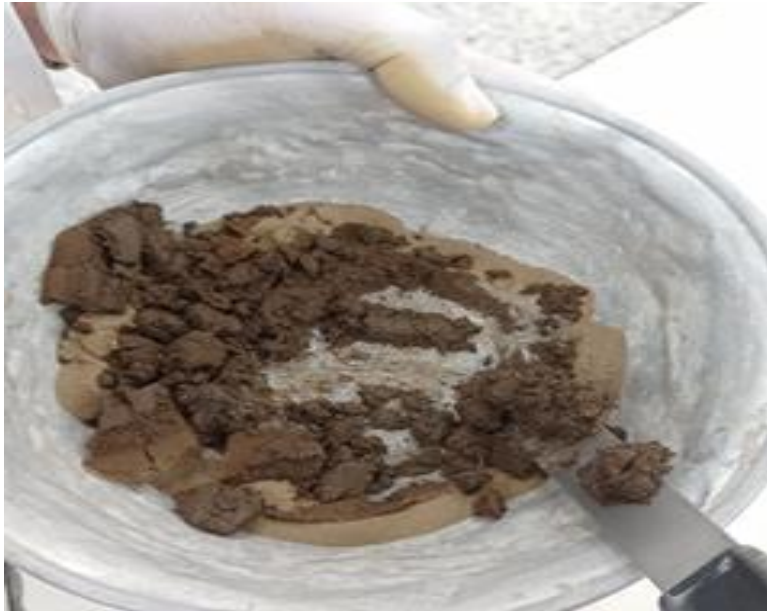
Figura 3-10: ensayo para determinar la plasticidad en el subsuelo.
