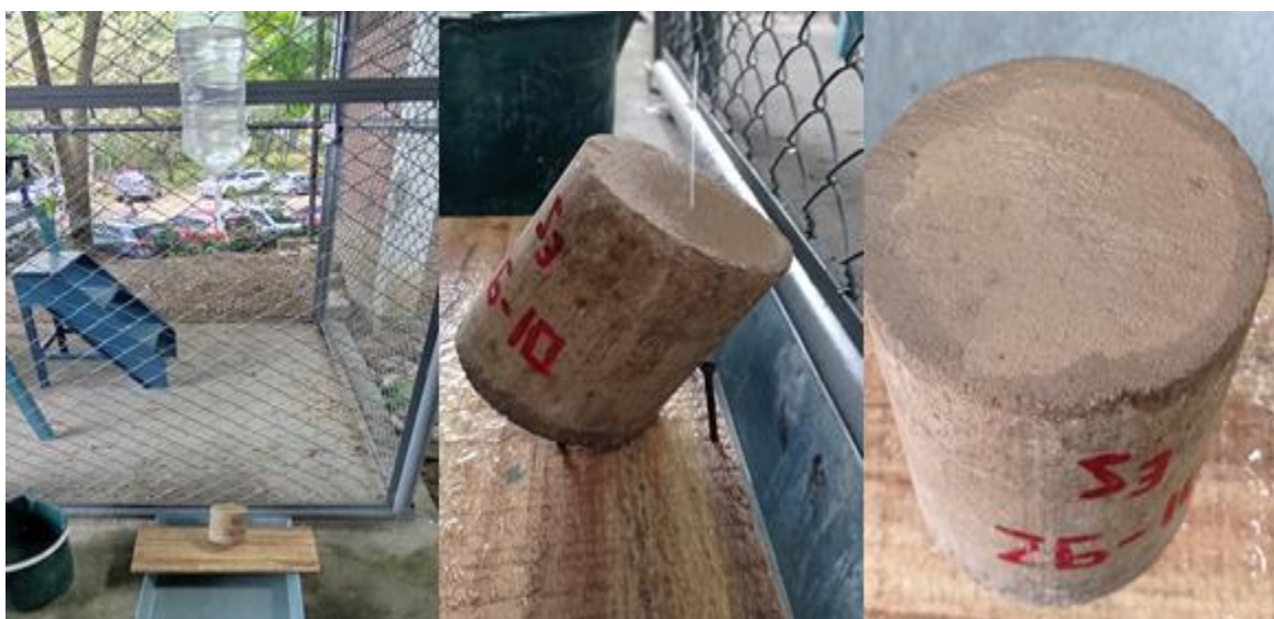
Figura 3-23: Ensayo de erosión acelerada.
