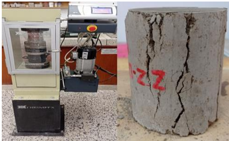
Figura 3-21: ensayo de compresión maquina universal.
