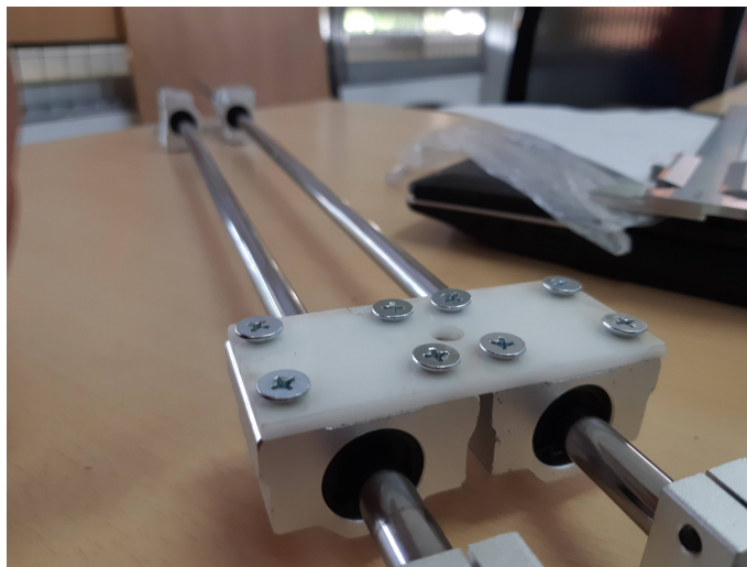
Figura 6. Lámina plástica con ocho perforaciones para acople de los rodamientos
