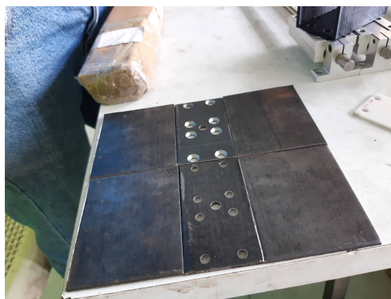
Figura 8. Paredes y bases de los vagones antes de ser unificados
