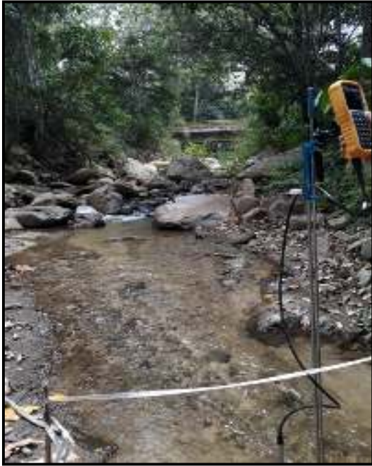
Foto 31 y 32. Aforo quebrada El Albadan (Antes de la derivación El Romero)
