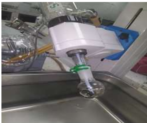
Figura 32. Rota-evaporación de las fracciones obtenidas en la cromatografía de columna del extracto hexánico.
