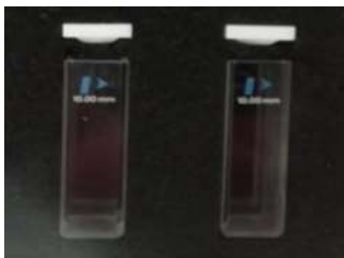
Figura 14. Celdas de cuarzo para espectroscopia UV/VIS.
