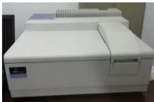
Figura 13. Equipo UV/VIS, serie 502508121003, modelo Perkin Elmer Lambda 35 del laboratorio de Química de la Universidad Surcolombiana.
