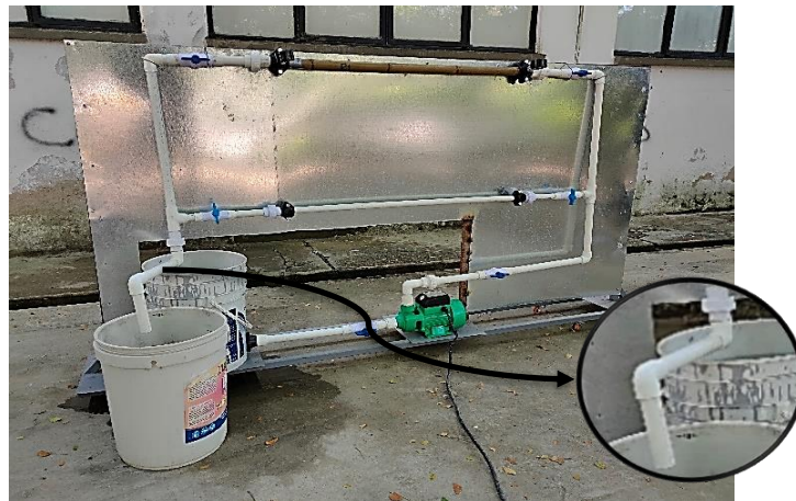
Ilustración 9. Acople de balde medidor a Montaje Banco Hidráulico
