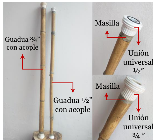
Ilustración 15. Acople unión universal en guadua con masilla
