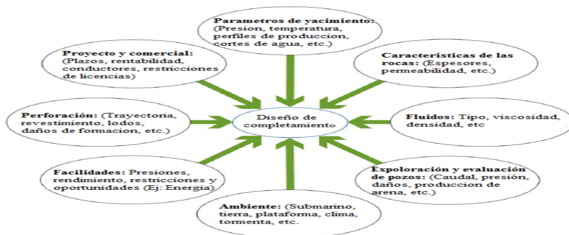
FIGURA 20. Fuente de datos para el diseño del completamiento. Fuente: Well Completion Design
