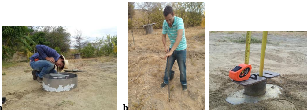
Figura 6. Pruebas hidrofísicas del suelo: a) Anillos concéntricos, b) Pozo barrenado invertido
