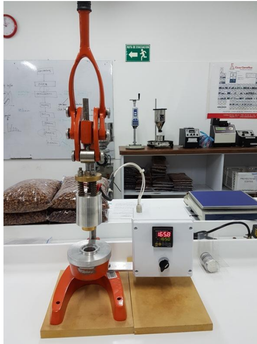
Figura 18. Encapsuladora manual, prototipo de laboratorio
