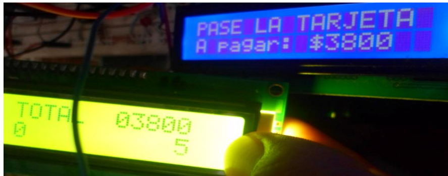
Figura 44. Transferencia de datos entre taxímetro y prototipo de pago
