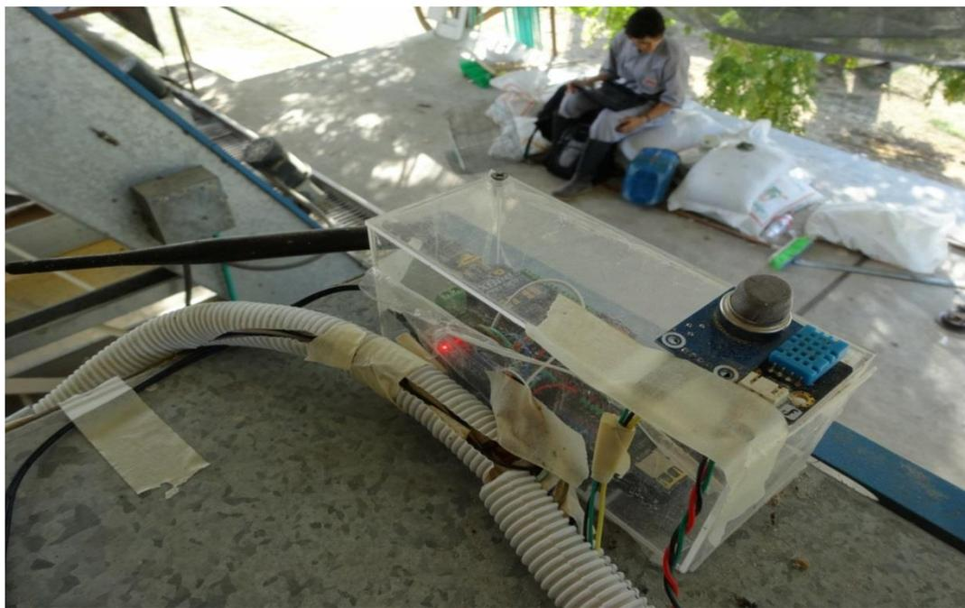
*Foto 5. XBEE, ARUINO Y SHIELD*
