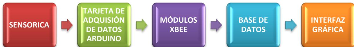
El sistema de monitoreo fue diseñada en tiempo de real, para que la transmisión de la información generada por los sensores de cada una de la bandas, al igual que el total del conteo se haga de forma efectiva.
