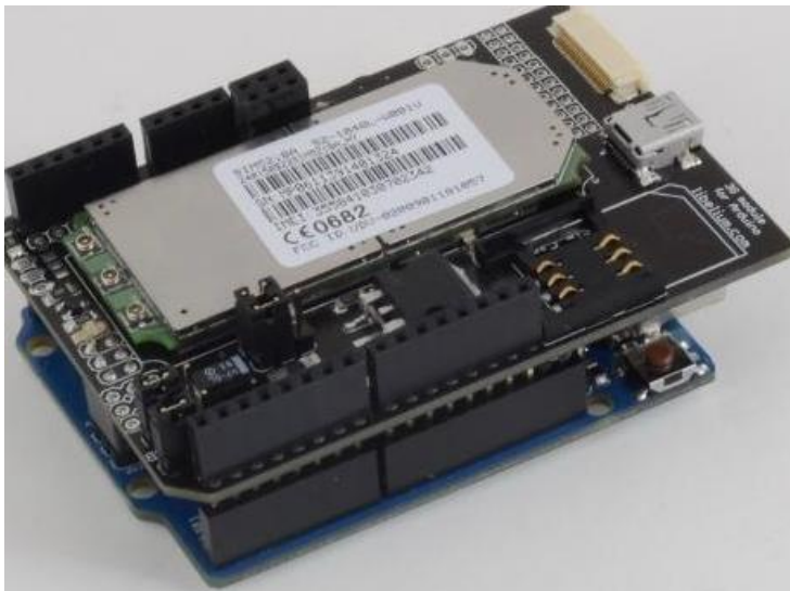
Figura 14. Conexión del Arduino con el módulo 3G/GPS
