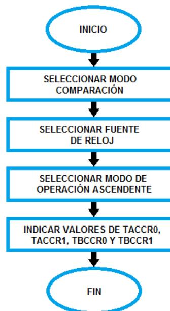
Los timer se configuran para que trabajen en modo comparación, este es el modo en el cual podemos generar señales PWM dependiendo de los valores que estén almacenados en los registros TXCCRY, donde X hace referencia al timer que se utilizará (A o B) y “Y” al canal de comparación en el cual se realizará el proceso. Además se selecciona como fuente de reloj el SMCLK y el modo de operación ascendente, para más información acerca de los registros del MSP430F2416 diríjase al Anexo A.
