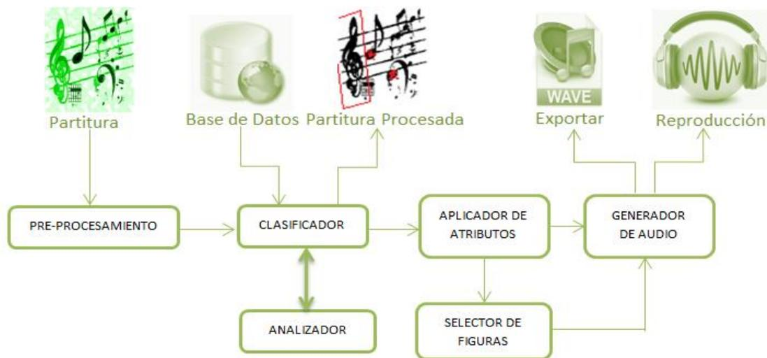
**Fig. 2** Diagrama en bloques del proyecto.
